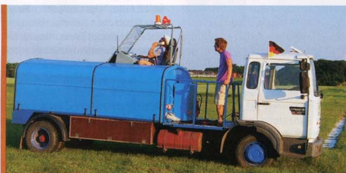
Die Elektrowinde im Betrieb mit Solarstrom.
