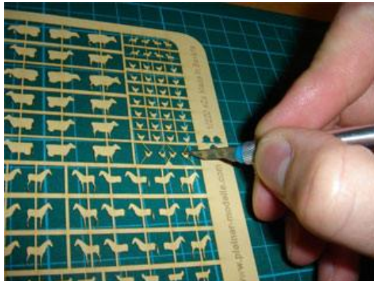
Mit dem Skalpell werden die einzelnen Schichten vorsichtig aus dem Bogen getrennt und an einem gemeinsamen Steg zusammengeklebt.
