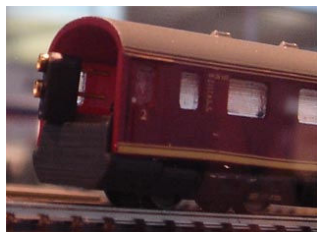
Das Handmuster ist extrem kurz gekuppelt und zeigt ein völlig neues Kupplungssystem für Spur-Z-Fahrzeuge.
