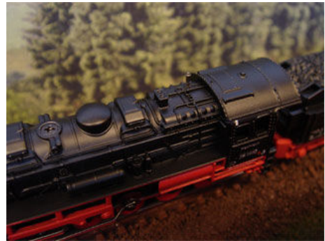
Der eckig wirkende Belpaire-Stehkessel, die beiden Sicherheitsventile und die Dampf-pfeife wurden überzeugend umgesetzt.
