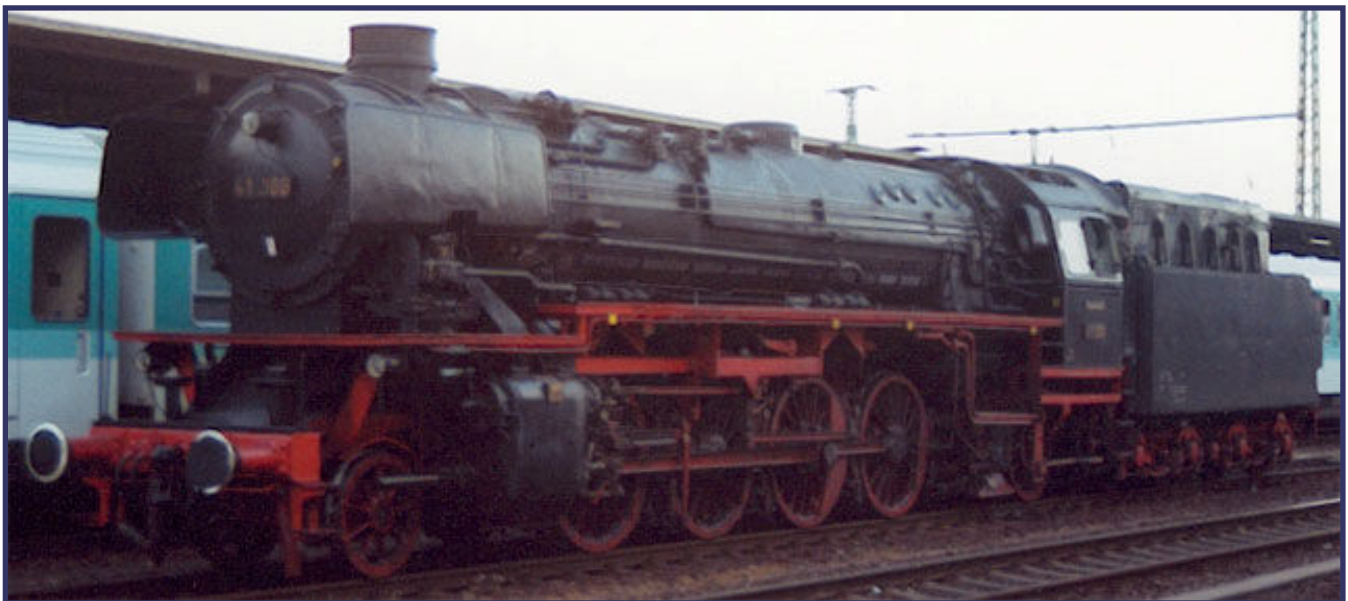
41 360 (ex 042 360-8) erhielt bei der DB einen Neubaukessel und wurde anschließend auf Ölfeuerung umgebaut. So gehörte sie 1977 zu den letzten Maschinen im Bestand der Bundesbahn beim Bw Rheine. Bis heute ist die Lok, die auf den Namen „Lady of Bismarck“ getauft wurde, beim Verein Dampflok-Tradition Oberhausen betriebsfähig erhalten (Aufnahme: Dortmund Hbf, Juli 1995).
