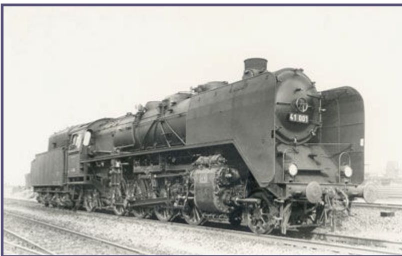
Den beiden Baumusterloks (mit genietetem Tender 2'2' T32) verdankt die Baureihe 41 ihren Spitznamen „Ochsenlok“. Die hier abgebildete 41 001 wurde vor ihrem Planeinsatz durch die Versuchsanstalt Grunewald messtechnisch untersucht. Nach dem Krieg verblieben sowohl 41 001 als auch 41 002 bei der DB.
