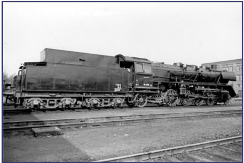
Diese Aufnahme zeigt 41 309 aus dem Bestand der DB. Sie besaß bis zuletzt einen dreidomigen Kessel, hat aber hier schon Windleitbleche der Bauart Witte erhalten. Außergewöhnlich ist der Tender 2'2' T32, mit dem die Serienlokomotiven nicht ausgeliefert wurden. Die Lok wurde am 24.2.1967 ausgemustert. Foto: DBMuseum; Archivnummer 41 309_MIN 720-51-11
