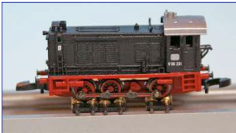
Die Gleitlager der KPF-Zeller-Prüfstände waren im Test die einzigen, die eine V36 mit allen Antriebsachsen aufnehmen konnten. Der Abstand der ersten beiden Antriebsachsen ist geringer als bei allen Märklin-Loks.
