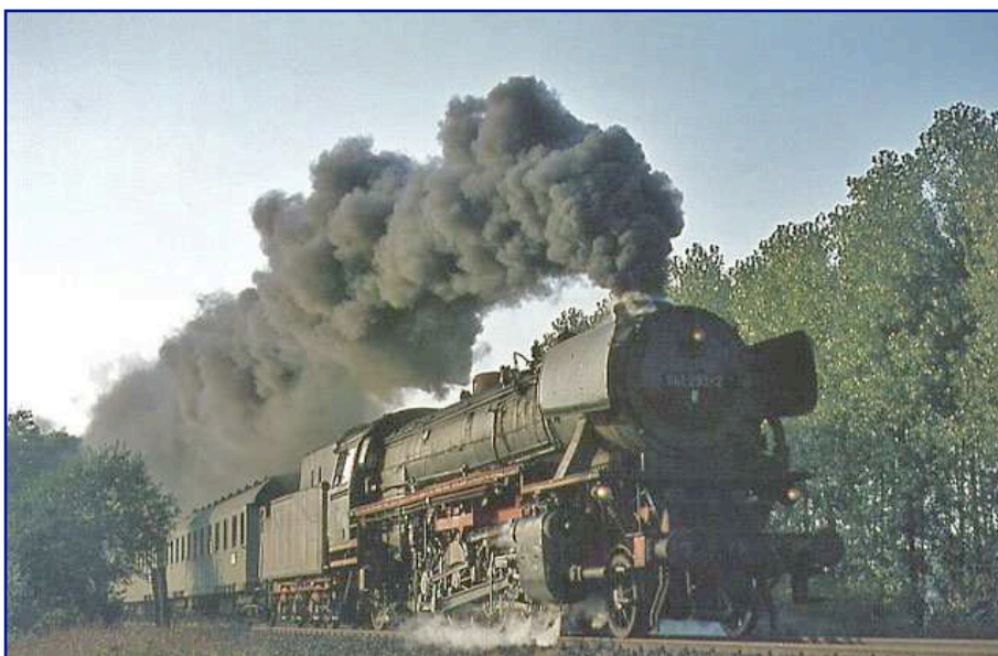
Die kohlegefeuerte 041 293-2 (Neubaukessel mit Altbautender 2'2' T 32) vor dem Militärschnellzug Dm 80045 Brüssel –Siegen, der aus Altbauwagen besteht, am 26.9.1970 bei Troisdorf. Foto: Helmut Dahlhaus
