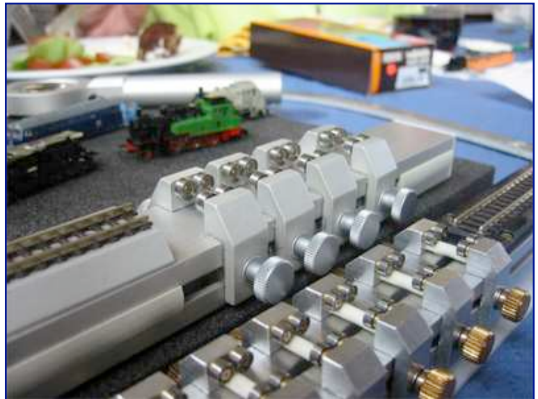
Der direkte Vergleich zeigt die konstruktiven Unterschiede des Klassikers von SMT (oben) und des Prüfstands von Rolf Palhegy, bei dem die Rollenböcke schmaler und beide Hälften durch eine Achse verbunden sind. Foto: Harald Möller
