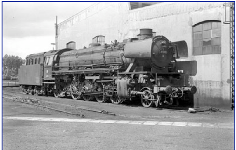
41 018 kam im Mai 1967 vom Bw Kirchweyhe nach Rheine. Hier wurde sie mit ihrem Spitzziffern-Nummernschild auf dem Freiland 19 so abgelichtet, dass Heintz-Misch-vorwärmer und Reglerabdeckung gut zu sehen sind. Ungewohnt ist die Ausstattung der Lok mit Dampflocke für den Nebenstreckendienst. Foto: Walter Patzke, Sammlung Petkelis
