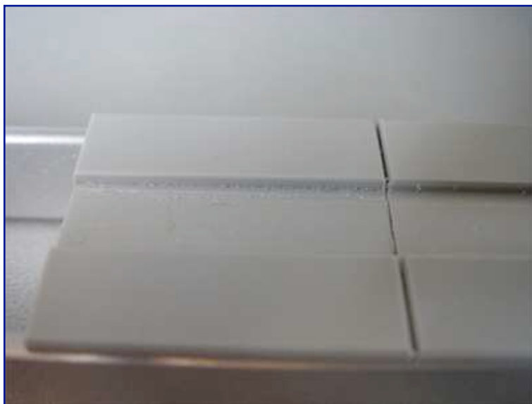
Auf die Finger geschaut: Die Makroaufnahme entlarvt auch kleinste Ungenauigkeiten bei der Materialbearbeitung im Herstellungsverfahren. Für die Betriebssicherheit ist dies nicht von Belang.
