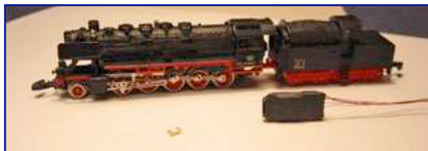
Im Rahmen des Umbaus wird der Decoder von JSS Elektronik im Tender Platz nehmen und über Kabel mit der Antriebseinheit verbunden. Foto: Roland Lohsträter
