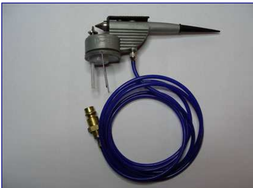
Götz Guddas hat für seinen Bedarf eine Revell-Spritzpistole umgebaut. Er kann seine Farbgläser nach dem Aufmischen so direkt unterschreiben, ohne umfüllen zu müssen. Foto: Götz Guddas
