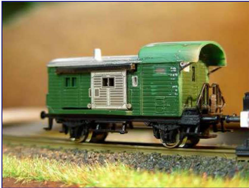
Der zur Probe wieder aufgebaute Wagenkasten zeigt bereits das angepasste Dach und die verschlossenen Fenster mit eingeritzter Bretterstruktur. Auch Dachverstärkung und Bühne sind fertig. Was noch fehlt, ist ein weiteres Fenster in der Stirnwand links neben der neuen Tür. Foto: Götz Guddas
