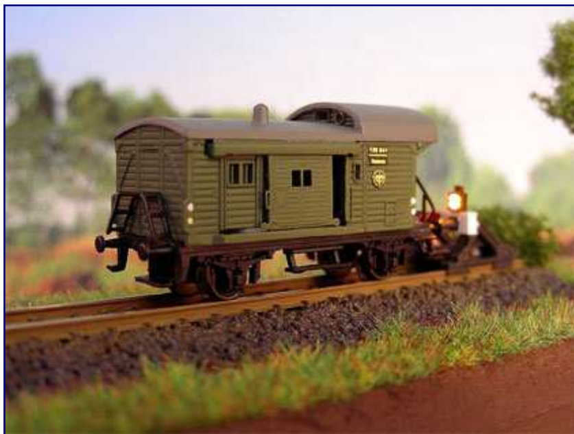
Die Schiebetüren sind eingesetzt und bleiben trotz ihrer guten Optik beweglich. Das Lackieren der oberen Führungsschiene wertet die Optik des Wagens enorm auf und schafft ein durchaus ansehnliches Modell, das sich immer noch für Ladeszenen eignet. Foto: Götz Guddas
