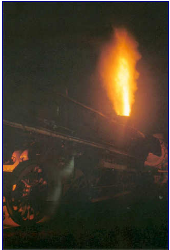
Eine lange Flamme schießt über 042 360-8 in den Himmel, als nach dem Abstellen der Brenner die Leitungen ausgeblasen werden – ein beliebtes Fotomotiv bei Dampffreunden. Foto: Udo Paulitz
