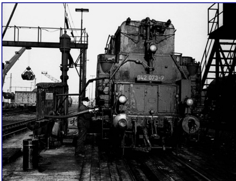
Herr Pausewang betankt im Bw Rheine die 042 073-7 über das Steigrohr – eine Besonderheit nur der Betriebswerke Emden und Rheine. Foto: Wolfgang Staiger
