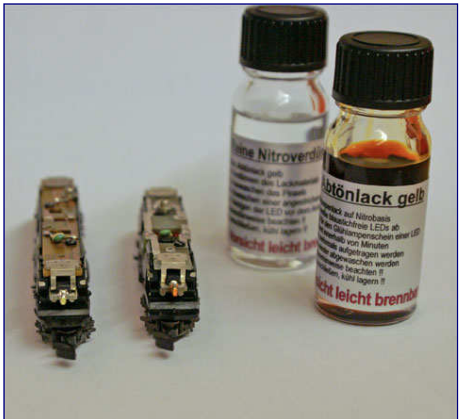
Die Glühlampen wurden gegen LED-Beleuchtungseinsätze von High Tech Modellbahnen ausgetauscht (links im Fahrgestell der 103). Auf die LED wurde mit dem Pinsel etwas gelber Abtönlack vom gleichen Hersteller aufgetupft (rechts im Bild eine so behandelte LED zum Vergleich).
