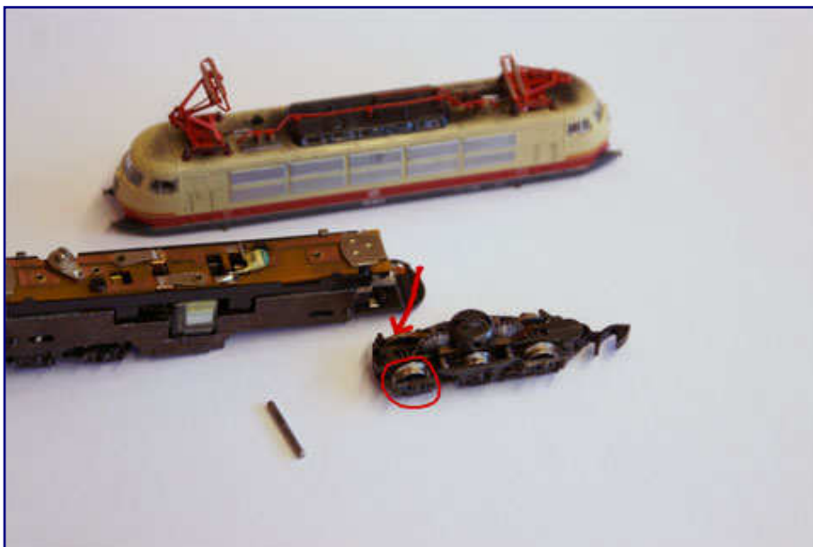
An der teilzerlegten Lok sind einige Modifikationen erkennbar: Auf der hinteren Achse wurde ein Jörger-Haftreifen aufgezogen (siehe Pfeil; ein weiterer befindet sich auf der gegenüberliegenden Seite an der Innenachse des zweiten Drehgestells). Die Radseitenflächen wurden für eine stimmige Optik schwarz lackiert (siehe Kreis).
