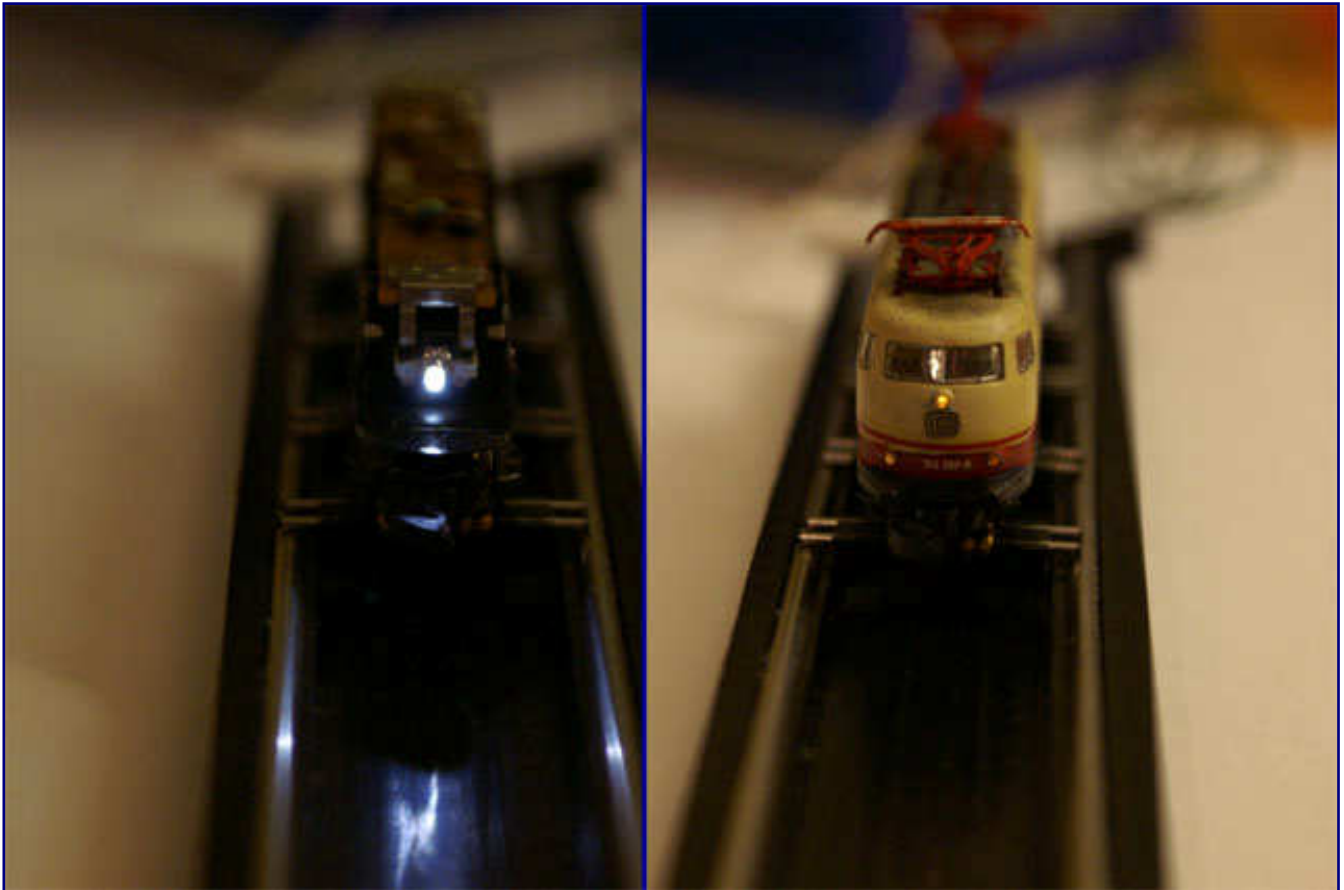
Das Farbspektrum der weißen LED-Bausteine im direkten Vergleich an der hier vorgestellten Lok: Während links die unbehandelte LED ein sehr kaltes und bläuliches Licht liefert, kommt die Lichttemperatur der abgetönten Leuchtdiode der ursprünglichen Glühlampe sehr nahe. Der Gewinn liegt in der Wartungsfreiheit und besseren Ausleuchtung bereits bei niedriger Fahrspannung.
