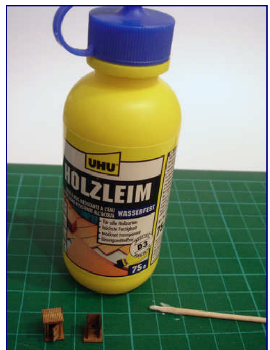
Der schnell trocknende Uhu Holzleim wird vorsichtig mit dem Zahnstocher auf die zu verbindenden Teile aufgetragen.
