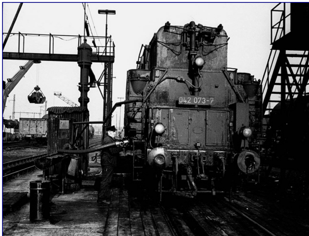
Herr Pausewang betankt 042 073-7 mit schwerem Bunkeröl. Auf diesem Foto ist mit Ölgalgen, Pumpenbude und dem Ölturm zur Füllstandskontrolle (rechts vom Gleis) die gesamte Tankanlage zu erkennen. Nur in Rheine und Emden wurde über ein Steigrohr im Tender direkt aus Kesselwagen der Brennstoff gebunkert. Foto: Wolfgang Staiger
