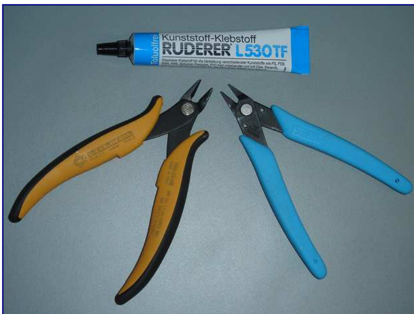
Wichtige Utensilien für den heutigen Umbauvorschlag: Spezialklebstoff Ruderer L530TF (oben), einen Kunststoff-Seitenschneider (links unten) und eine Pinzettzange (unten rechts) zum Biegen der Aufstiege.
