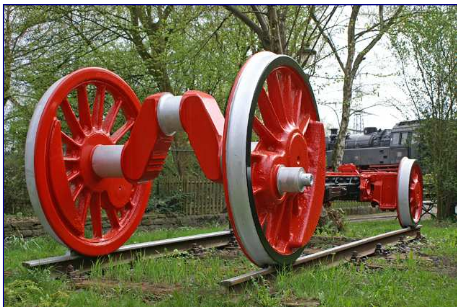
Viele Jumbos blieben erhalten, wenn auch teilweise nur in einzelnen Baugruppen. An diesem Treibradsatz lässt sich die Kröpfung für den Mittelzylinder gut erkennen, ebenso der Versatz von jeweils 120 Grad, mit dem die drei Zylinder auf die Achsen arbeiteten.
