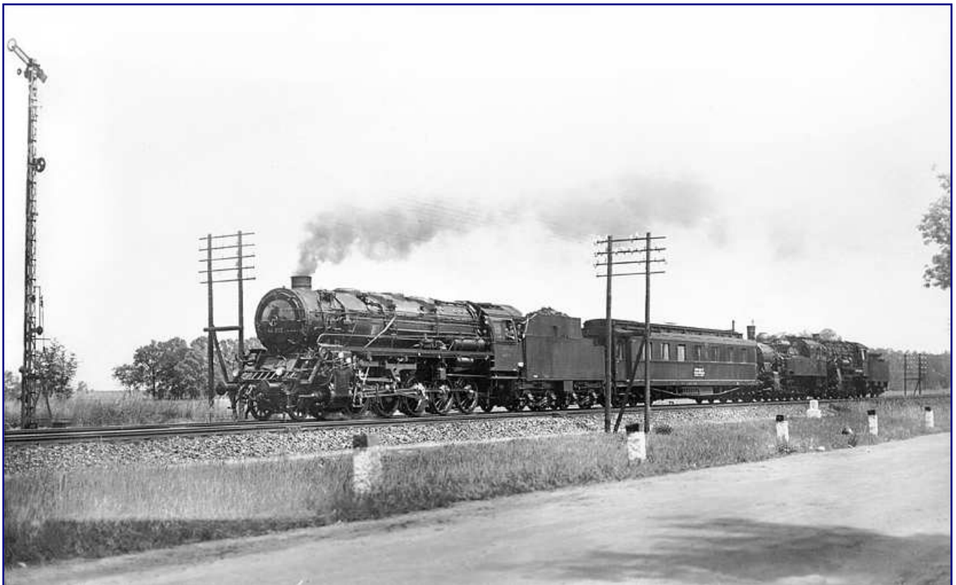
Sonderlinge innerhalb der Baureihe 44 waren die beiden Mitteldrucklokomotiven für 25 atü Kesseldruck, mit denen die Deutsche Reichsbahn Versuche anstellte, um die Wirtschaftlichkeit der Dampflokomotive zu steigern. Am 11. Juli 1933 ist die neue 44 012 mit einem Messwagen der LVA Grunewald sowie den Bremslokomotiven 94 1301 und 56 113 bei Brandenburg unterwegs. Nach dem Krieg gelangte sie zur VES-M Halle und erhielt eine Rigggenbach-Gegendruckbremse. Foto: Carl Bellingrodt, Sammlung Eisenbahnstiftung
