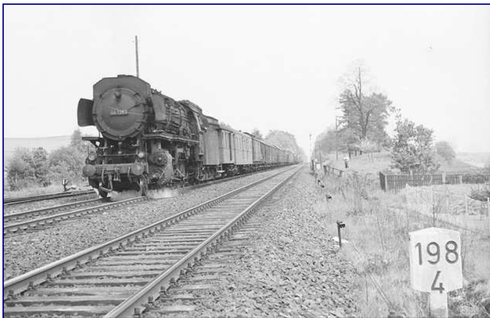
44 1383 gehörte zu den DB-Lokomotiven, die versuchsweise mit Mischvorwärmern ausgestattet wurden. Als einzige dieser Lokomotiven erhielt sie einen Knorr-Mischvorwärmer mit zweistufiger Kolbenpumpe, der im Versuch zu den größten Brennstoffersparnissen führte. Alle anderen Maschinen erhielten die Bauart Henschel mit Turbospeisepumpe. Foto: Walter Patzke, Sammlung Petkelis
