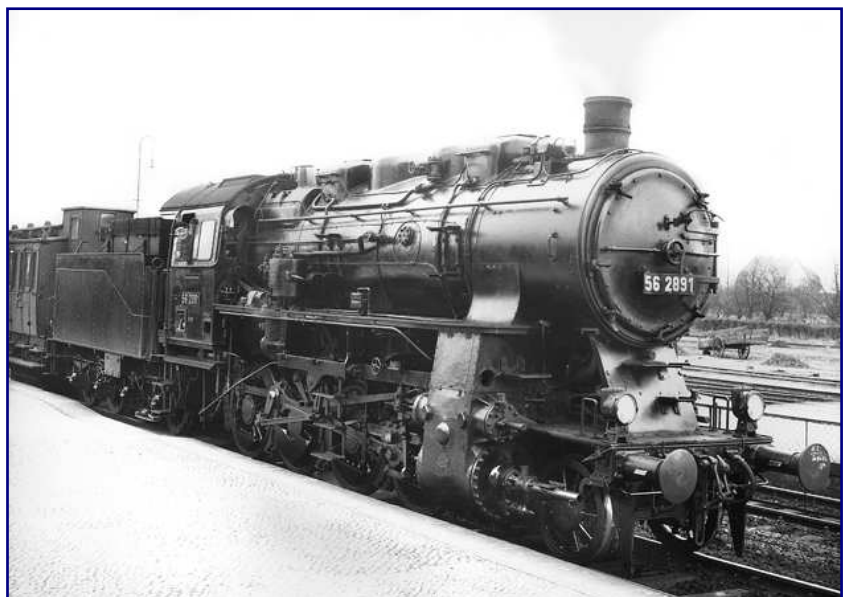
Bis weit in die dreißiger Jahre trugen Länderbahnmaschinen die Hauptlast des schweren Güterverkehrs. Teilweise wurden sie dafür durch nachträgliche Ausrüstung mit Vorlaufachsen ertüchtigt. 1935 absolvierte 56 2891 auf der Strecke Ludwigslust – Wittenberge Indusi-Erprobungsfahrten. Foto: Walter Hollnagel, Sammlung Eisenbahnstiftung
