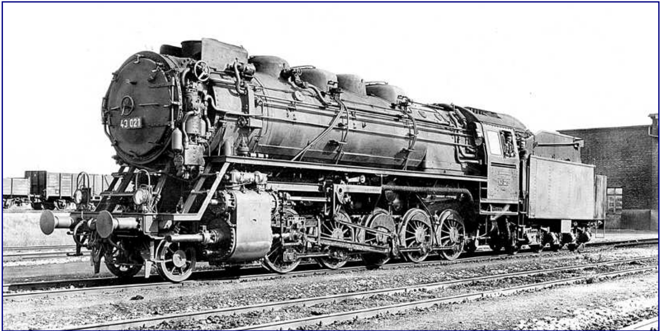
Am 16.3.1934 zeigt sich 43 021 im Bw Chemnitz-Hilbersdorf mit „kleinen Ohren“: Versuchsweise rüstete die Deutsche Reichsbahn verschiedene Dampflokomotiven mit abweichenden Windleitblech-Bauarten aus, um den besten Kompromiss zwischen Wirkung und Streckensicht zu finden. Ausgerüstet ist die zweizylindrige Schwesterbauart der 44 mit einem Niettender 2'2 T32. Schon bald hatte diese Baureihe gegenüber der BR 44 wegen ihrer geringeren Leistung und Höchstgeschwindigkeit das Nachsehen. Foto: Werner Hubert, Sammlung Eisenbahnstiftung
