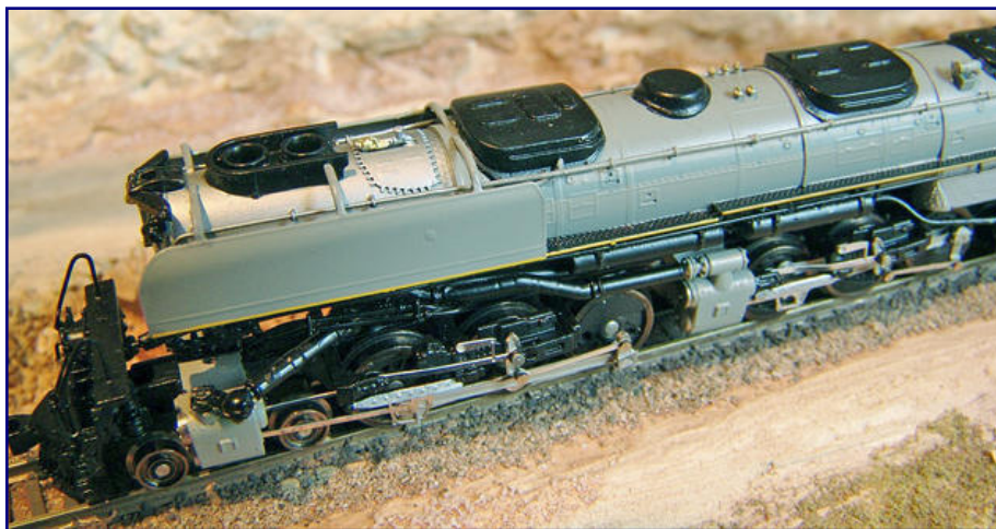
Die Sandkästen und Dome schmiegen sich eng an den riesigen Kessel der Dampflok, damit das Lichtraumprofil eingehalten werden kann. AZL hat diesen Eindruck gelungen wiedergegeben. Foto: Jöns Wimmel
