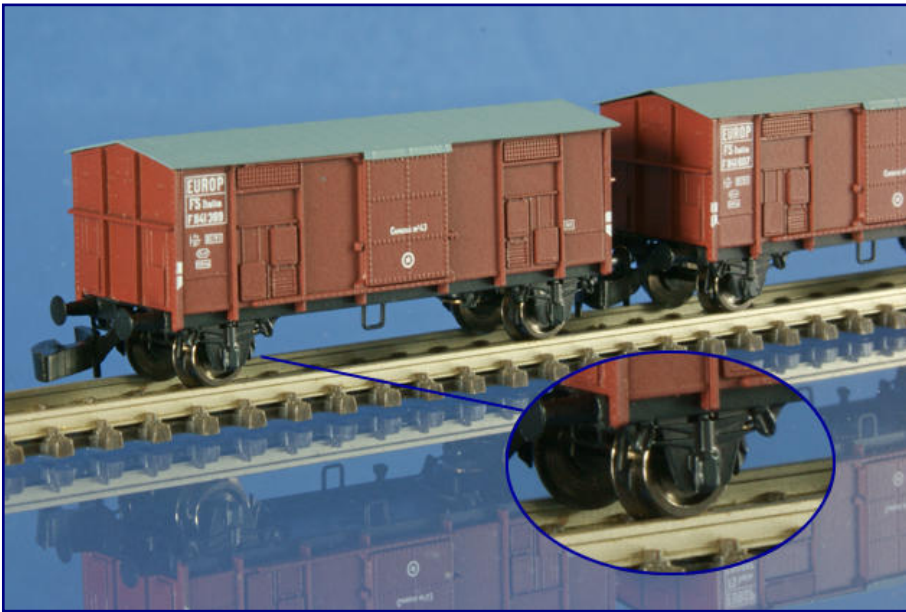
Ein markantes Merkmal vieler italienischer Wagen waren auch doppelte Blattfederpakete. FR leistet sich auch hier keinen Kompromiss (siehe Ausschnittsvergrößerung). Weiterer Pluspunkt: Die Bremsennachbildungen liegen auf Radniveau.
