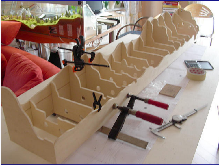
Die Spantenbauweise ist allen anderen Techniken überlegen, stellt aber hohe Anforderungen an den Modellbauer. „Sägethal“ entstand auf diese Weise. Foto: Götz Guddas
