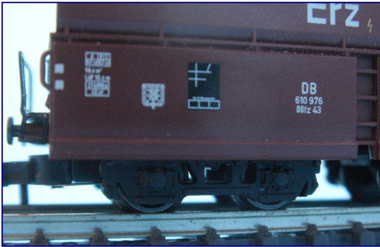
Der OOtz 43 lief beim Vorbild mit verschiedenen Drehgestellen. Märklin hat seinen Jahreswagen 2011 (Art.-Nr. 80321) mit Pressblechdrehgestellen der Reichsbahn ausgestattet.
