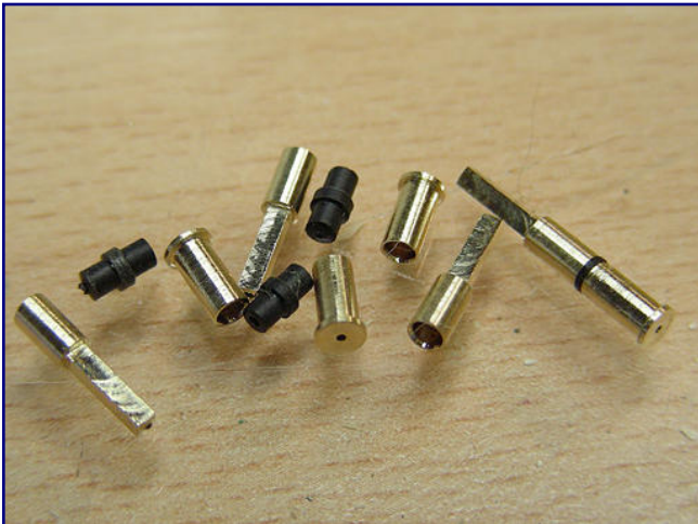
Eine ausgeklügelte Mechanik sorgt für die Drehbewegung der Weichenlaternen ohne Spannungsunterbrechung. Zweigeteilte Wellen mit Isolierung und Vierkantaufnahme am unteren Ende (linkes Bild) bilden die Drehachse. Die Grundplatten und Platinen vervollständigen die Laterneneinheit (rechtes Bild).
