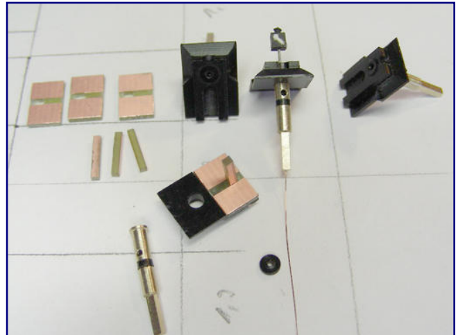
Eine ausgeklügelte Mechanik sorgt für die Drehbewegung der Weichenlaternen ohne Spannungsunterbrechung. Zweigeteilte Wellen mit Isolierung und Vierkantaufnahme am unteren Ende (linkes Bild) bilden die Drehachse. Die Grundplatten und Platinen vervollständigen die Laterneneinheit (rechtes Bild).
