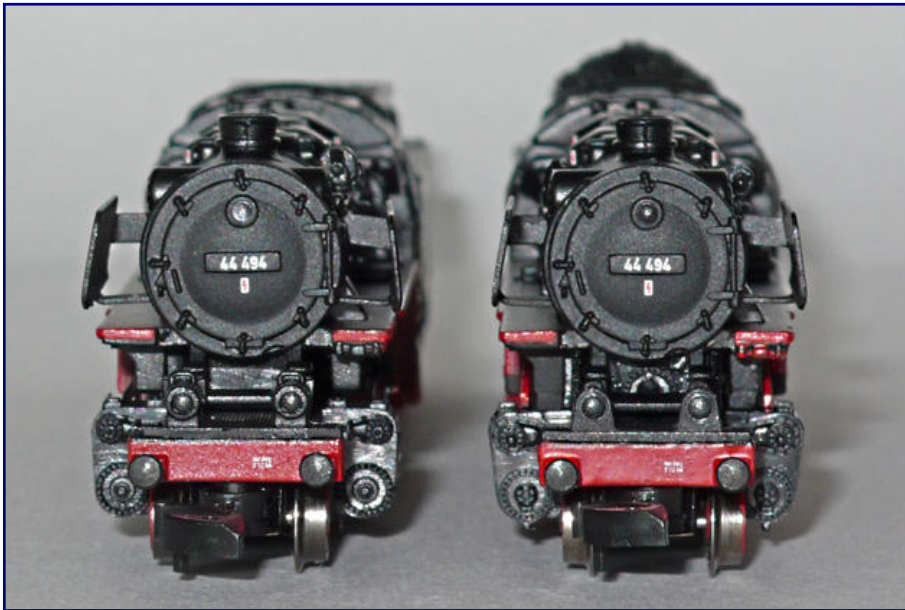
Der direkte Vergleich vorher (links) und nachher (rechts) offenbart auch die viel zu große Lichtmaschine (hier rechts vom Schlot am Kessel) in Spur-N-Dimensionen, mit der das Modell von Märklin ausgeliefert wurde. Foto: Jochen Brüggemann
