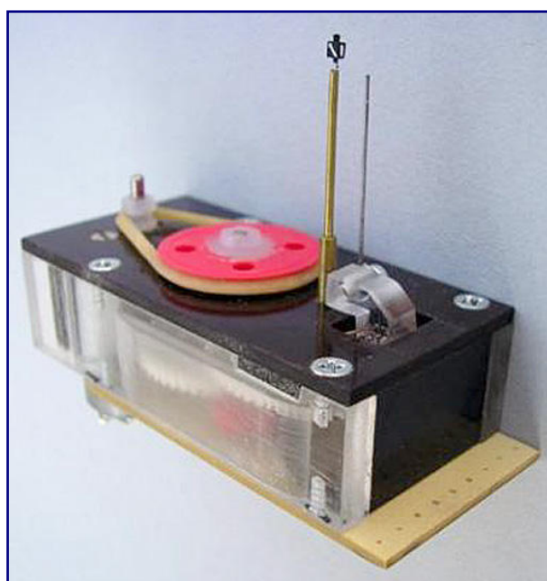
Weichenantrieb mit drehender und beleuchteter Laterne. Foto: Eckhard König
