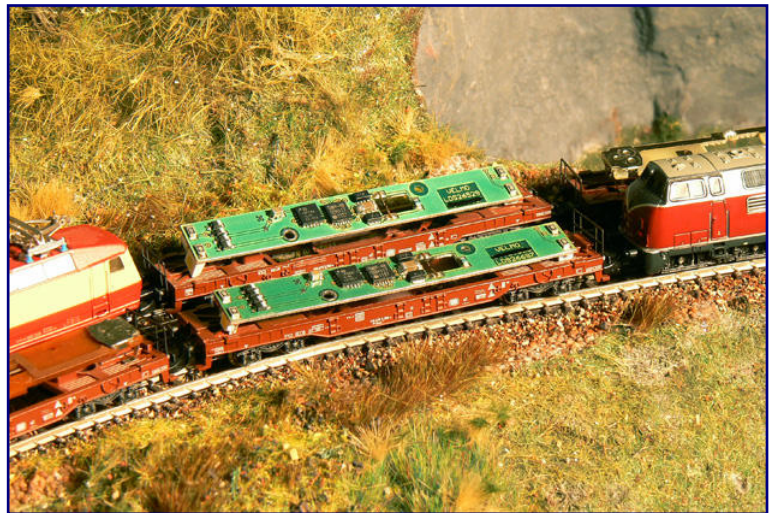
Neu bei Velmo sind digitale Tauschplatinen mit Multiprotokolldecodern neuester Generation für Märklins Baureihen 120 (hinten) und 221 (vorne). Foto: Velmo
