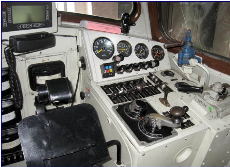
Einfach, aber funktionell war der Führertisch einer V 200 0 . Gegenüber dem Ursprungszustand sind bei Museumslok V 200 033 Zugbahnfunk (links oben) und der Leuchtmelderblock der PZB 90 (unterhalb des Geschwindigkeitsanzeigers) hinzugekommen. Foto: Alwin Meschede
