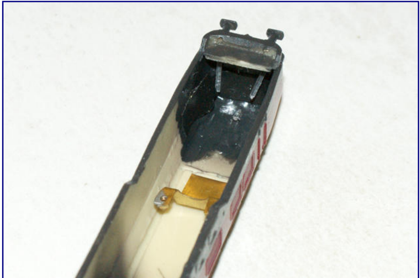
Im Inneren des Führerhausbereiches eingeklebt, schwarzes Isolierband sorgt für eine vollständige Lichtabschirmung der Leuchtdioden.
