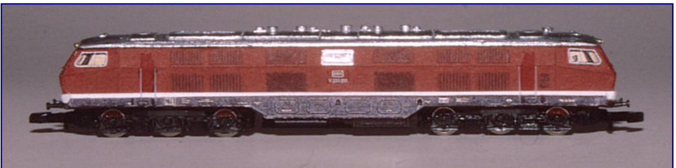
Auf den Seitenwänden kamen separat aufgesetzte Führerstandstüren, eine geklebte Trennlinie zwischen Rahmen und Aufbau sowie Farbkopien zum Einsatz.
