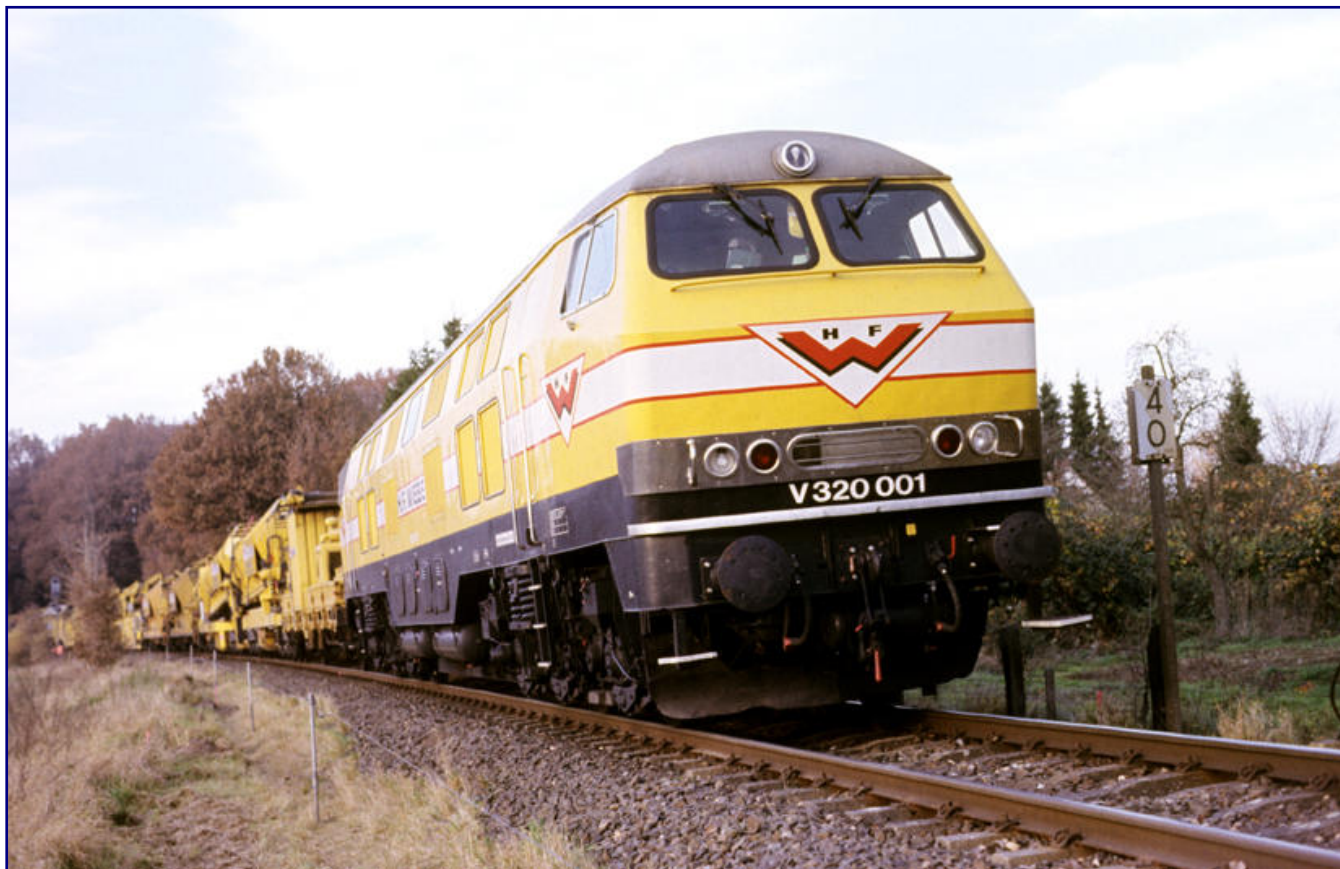
Als V 320 001, intern auch als Lok Nr. 6 bezeichnet, kehrt die Diesellok im Jahr 2000 für die Gleisbaufirma Wiebe auf die deutschen Strecken zurück. Dort zieht sie die Schnellumbau- und Bunkerzüge, wird aber auch an Dritte vermietet. Übrigens trägt die Lok nun zwei runde Puffer. Foto: Sammlung Petkelis
