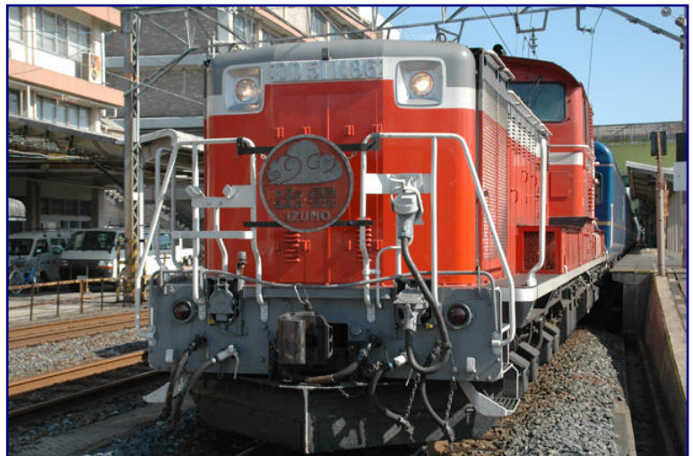
Vorbild für Rokuhans erstes Spur-Z-Modell: die sechsachsige Diesellok DD51 der japanischen Eisenbahnen im Ursprungsanstrich. Foto: takada@mex.ad.jp
