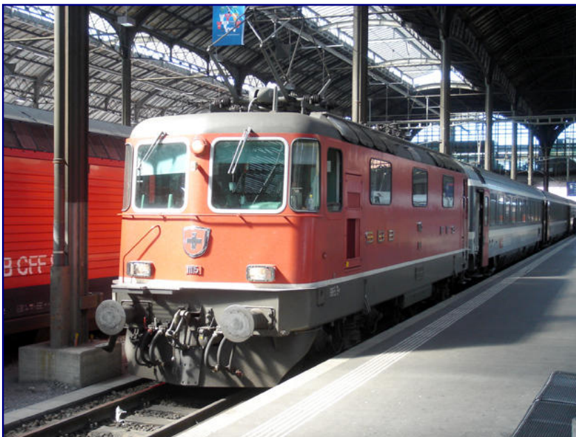
Die Lokomotiven der ersten Serie weichen in einigen Merkmalen von den später gebauten Lokomotiven ab. Zum Beispiel tragen sie nur einen Stromabnehmer. Re 4/4 III 11115 wartet vor einem Eurocity nach Mailand am 20. September 2007 auf Abfahrt in Basel SBB.
