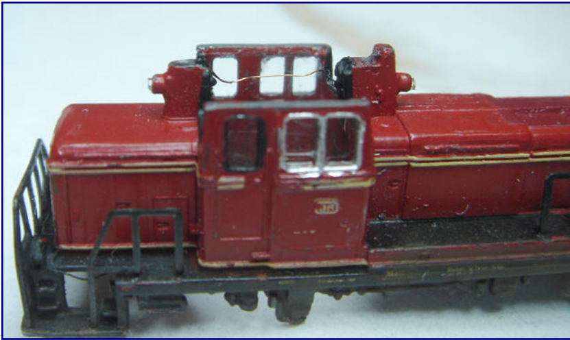
Zu erkennen ist hier der Kupferlackdraht zwischen den beiden Leuchtdioden für die oberen Spitzenlichter. Eingesteckte Lichtleiter transportieren das Licht nach draußen. Auf dem rechten Vorbau ist am Rand der große Ausbesserungsflecken zu sehen.
