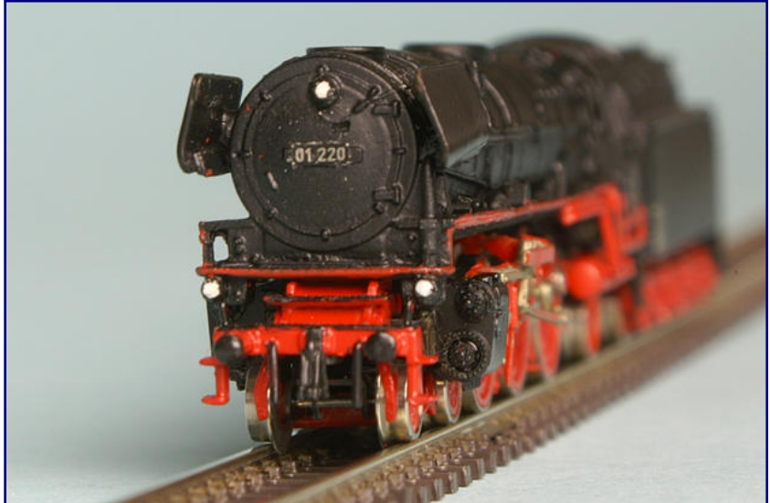
An der Lokfront wurden alle Laternen farblich behandelt und das Lokschild aufgebracht. Das wahre Alter des Modells zeigt sich in diesem Bereich besonders an den Details des Mischvorwärmers sowie den Formen von Schienenräumer und Bremsschläuchen.
