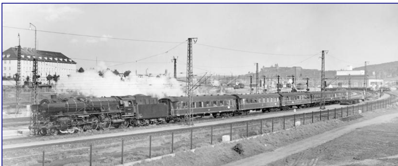
Auch bei der DB wurde die Baureihe 01 noch für lange Zeit im hochwertigen Dienst eingesetzt: Die mit Kesselringen bemalte 01 229 (Altbaukessel) durchheilt im Jahre 1955 vor F 53 „Domspatz“ (Regensburg - Hamburg-Altona) den Rangierbahnhof Würzburg-Zell. Foto: Carl Bellingrodt, Sammlung Eisenbahnstiftung
