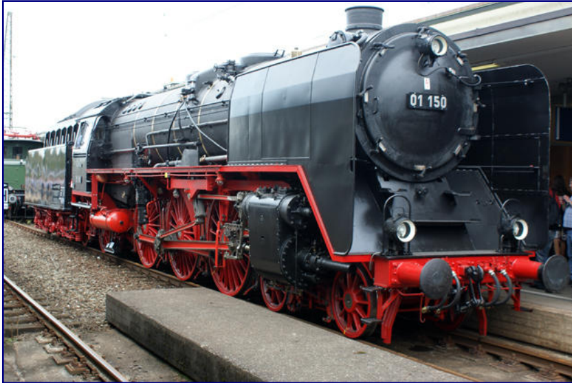
Die bekannteste Lok ihrer Baureihe dürfte wohl 01 150 sein: 1935 an die DRG geliefert, nahm sie an den Paraden zum 100. und 150. Geburtstag der deutschen Eisenbahnen teil. Bei ihrer Präsentation in Göppingen 2011 ist sie an der Lage der Wasserpumpe trotz (formaler) Reichsbahn-Beschilderung leicht als DB-Maschine zu erkennen.
