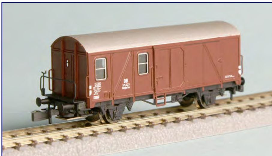
Korrekt ist auch die Nachbildung der Einstiegstür an der vorbildrichtig gestalteten Rangiererbühne. Am Wagenkasten fehlen leider die UIC-Ösen am Ende der Außenstreben – ein vermeidbarer Fehler.
