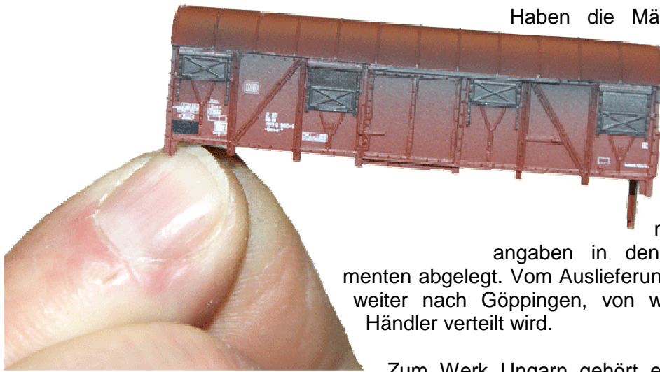
Dieses Güterwagengehäuse gehört zur Schienenbuspackung 88313. Bedruckt wurde es maschinell, die Lüftungklappen und Alterungsspuren wurden von Hand gespritzt.
