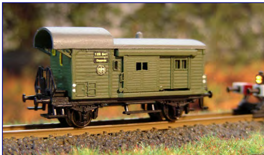
Als Umbau aus Märklins 8609 entstand dieser preußische Begleitwagen der späteren Bauart Pwgi Pr 99. Foto: Götz Guddas
