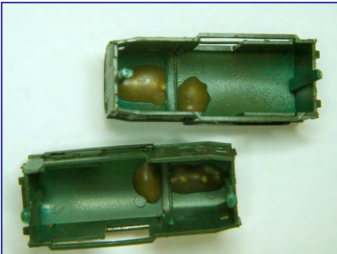
Die ins Dach eingesetzten Lüftungselemente aus Eigenbau sitzen für perfekten Halt in kleinen Bohrungen (oben) und wurden von innen großzügig mit Uhu Acrylit verklebt (unten).
