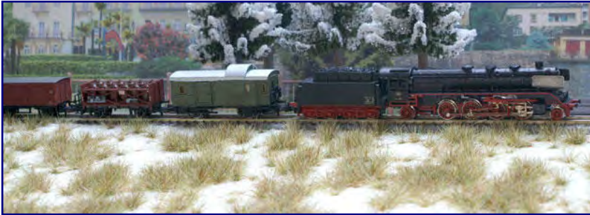
Ein weiterer Umbau von Bernd Jablonksi: Auf Basis des Donnerbüchse-Packwagens hat er den schnelllaufenden Pwgs 41 nachgebildet, der hier mit Dachkanzel für die DB läuft.
