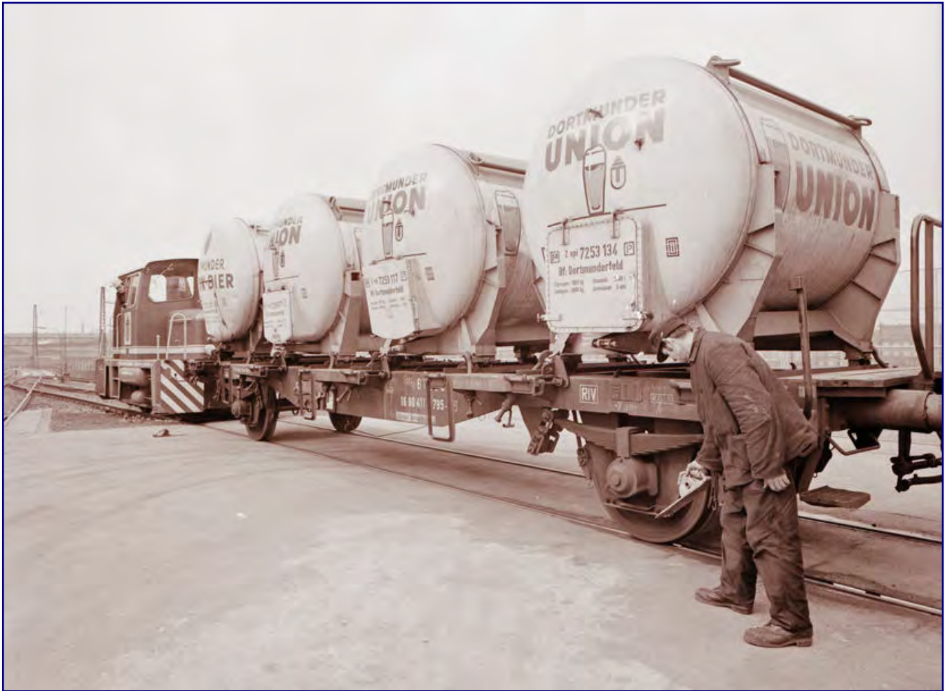
Die zweiachsige Diesellok rangiert am 13. Februar 1974 einen Privatwagen BTms 55 auf dem Werksgelände. Diese Bauart war der größte Behältertragwagentyp im Bestand der DUB. Foto: Harald Koechlin (Archivnummer 1545-6)
