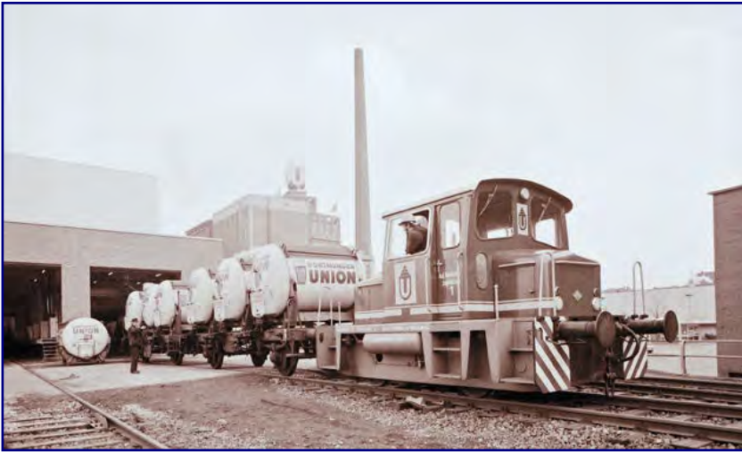
Die O&K-Werkslok (Bauart B' dh) rangiert am 23. Februar 1974 zwei firmeneigene Tragwagen BT 10 in den DUB-Containerbahnhof. Foto: Foto-Studio Harald Koechlin (Archivnummer 1545-8)
