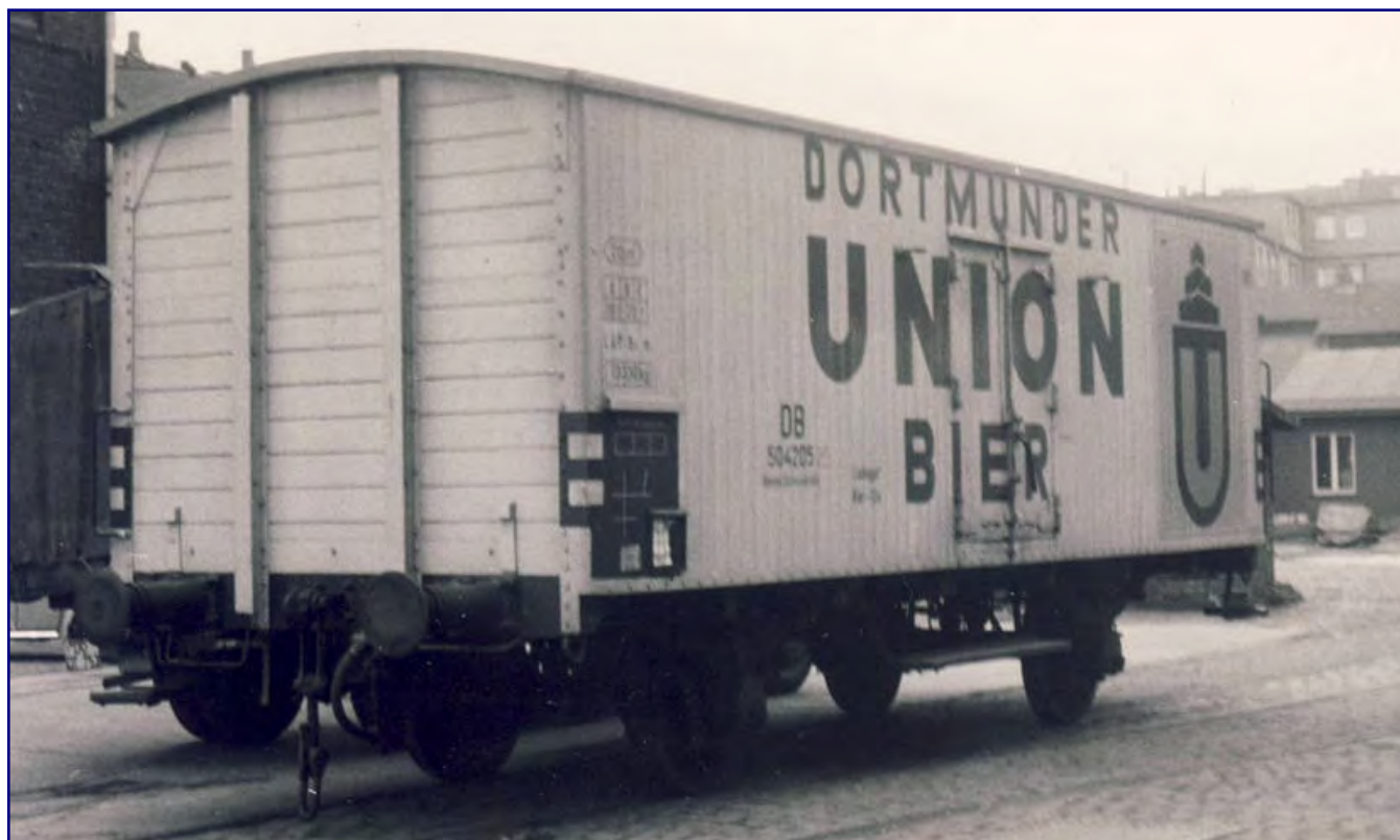
Die konkreten Vorlagen für die beiden im Modellartikel beschriebenen Umbauten: Wagen 504 208 (oben) ist mit seinen Anschriften und den außergewöhnlichen Bremsecken am 25. Februar 1961 auf dem Werksgelände abgelichtet worden. Bei Wagen 504 205 (unten) lässt sich wegen des diffusen Lichtes die orangefarbene Fläche um das Firmenlogo (U mit Gebäudesilhouette darauf) besser erkennen. Andere Fotografien zeigen, dass er auch 1968 noch in diesem Zustand unterwegs war. Quelle: Westfälisches Wirtschaftsarchiv, Dortmund, Archivbestand F188 Dortmunder Union-Brauerei, Nr. 6158-12 (oben) & 6158-14 (unten)
