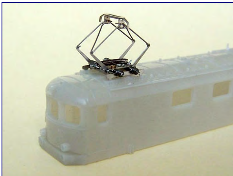
Der neuentwickelte Schweizer Scherenstromabnehmer auf dem Dach des Handmusters der Re 4/4 1 der Z-Bahn GmbH. Foto: FR Freudenreich Feinwerktechnik
