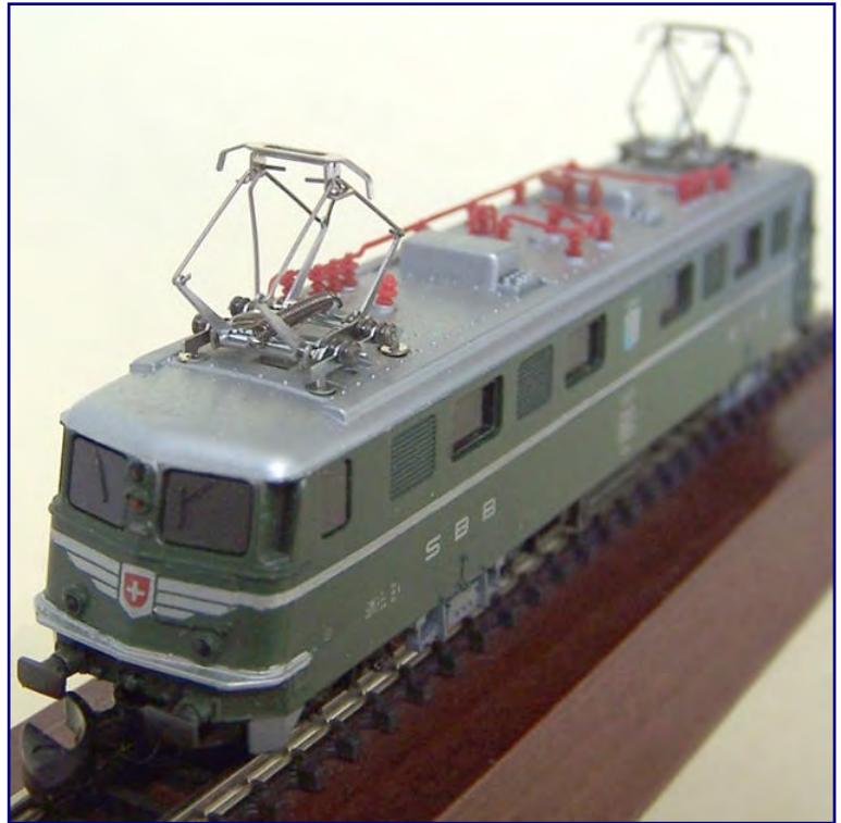
Die Neuentwicklung passt auch zu verschiedenen Modellen von Märklin (im Bild) und SZL. Die Aufnahmen der bisherigen Isolatoren werden dann mit einer Scheibe abgedeckt. Foto: FR Freudenreich Feinwerktechnik
