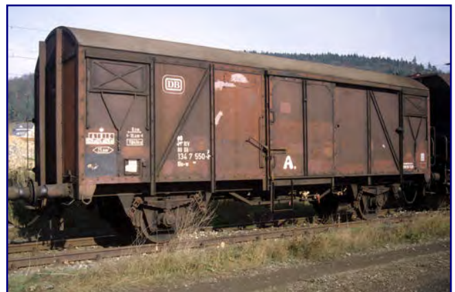
Als Vorlage fürs sein Modell hat FR die Ausführung mit Bremserbühne ausgewählt (Bild links). Der Wagen absolvierte seine letzten Betriebsjahre, als er am 30. September 1989 in Landeck aufgenommen wurde. Bereits abgestellt ist der Wagen im rechten Bild, der am 1. November 1995 in Immendingen fotografiert wurde. Wagen ohne Bremserbühne machten ungefähr drei Viertel des Gesamtbestands dieser Gattung aus. Fotos: Eckerle, Sammlung Petkelis
