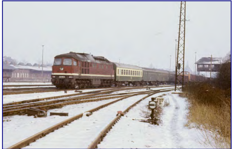
Der Durchbruch für die V 300 der DR kam 1973 mit der Baureihe 132 – sie war mit der im Winter unverzichtbaren, elektrischen Zugheizung in Serienausführung ausgestattet. 132 596-8 fuhr dem Fotografen am 17. Februar 1986 in Görlitz vor die Linse. Foto: Sammlung Petkelis
