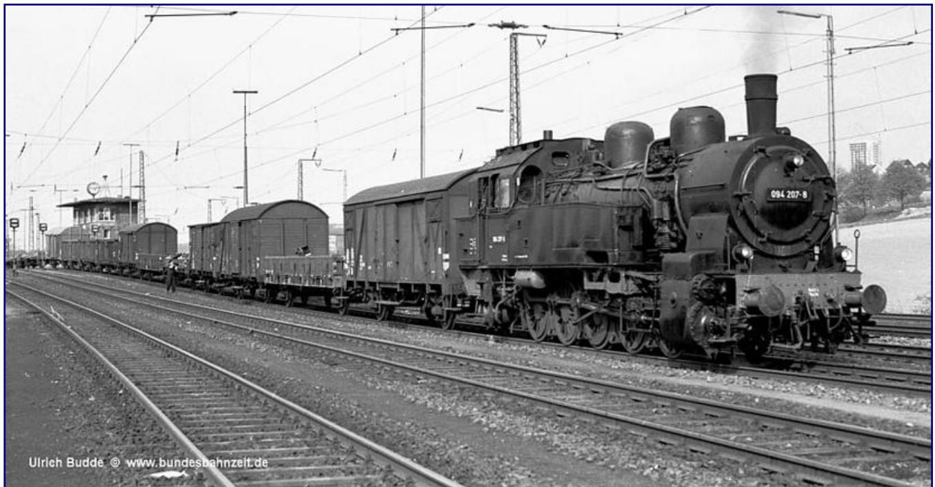
Die Hauptaufgabe der Baureihe 94 5-17 war der schwere Vershubdienst, wie hier in Wuppertal-Vohwinkel am 9. Mai 1970. 094 207-8 besitzt das Führerhaus mit flacherer Wölbung und Entlüftungsöffnungen. Foto: Ulrich Budde (Bundesbahnzeit)
