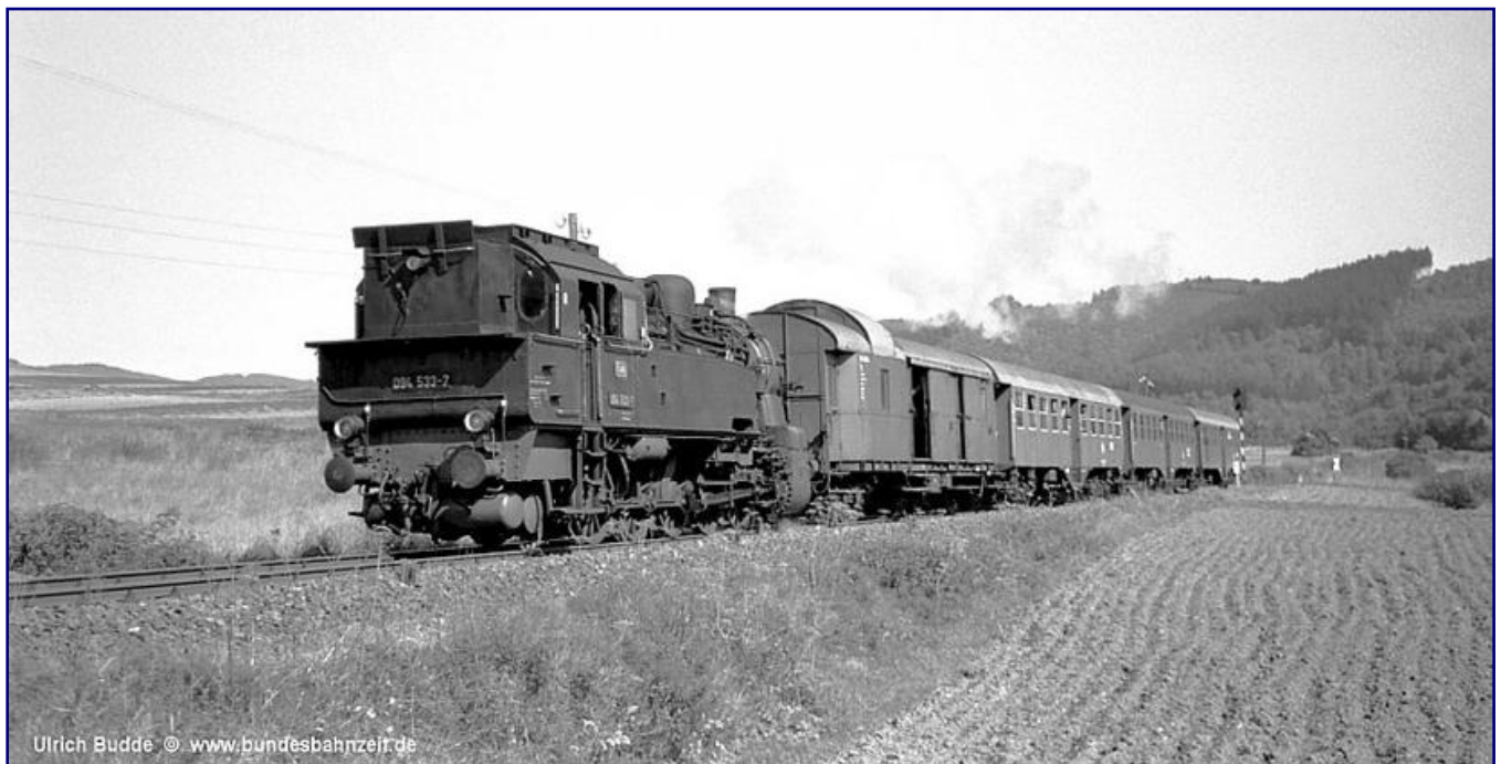
Das Bw Dillenburg setzte seine Vierundneunziger bis 1972 im Personenzugdienst auf Steilstrecken ein. So eignet sich auch diese Garnitur als Anregung für die Modellbahn. Typisch ist der geschweißte Kohlenkastenaufsatz, der das Fassungsvermögen erheblich vergrößerte. Foto: Ulrich Budde (Bundesbahnzeit)
