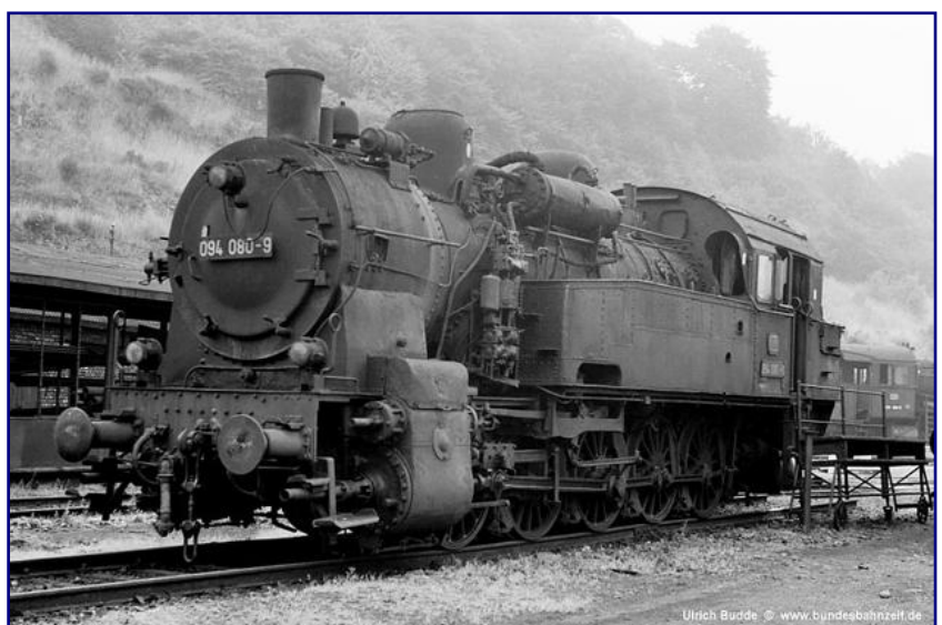
Wegen des zusätzlichen Doms auf dem Kessel musste die Lage des Vorwärmers geändert werden. 094 080-9 besitzt neben der ursprünglichen Führerhausausführung eine besondere Form der Rangierhaltestangen auf der vorderen Pufferbohle. Foto: Ulrich Budde (Bundesbahnzeit)
