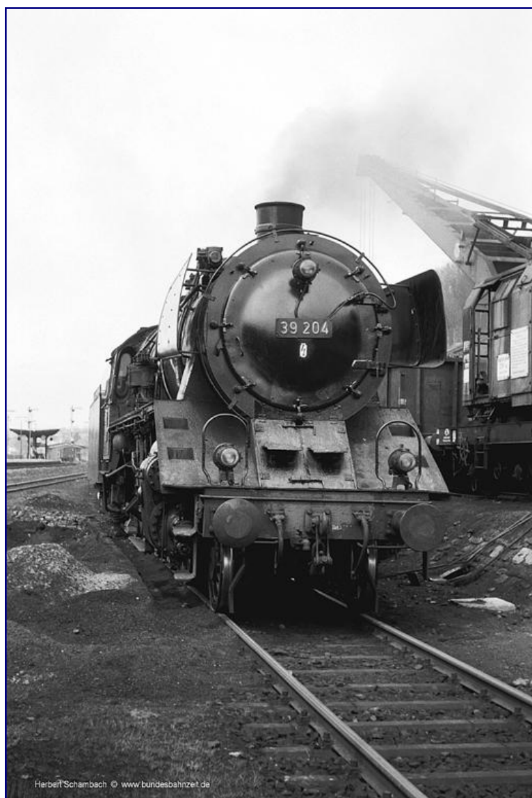
39 204 vom Bw Jünkerath zeigt am 23. April 1966 zwar DB-Reflexglaslaternen, aber die ursprünglichen Lampenbügel sind (nicht nur) ihr bis zum Schluss geblieben. Foto: Herbert Schambach
