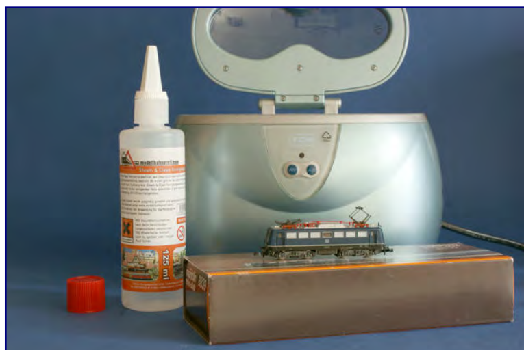
Eine schnelle und effiziente Methode zur Reinigung eines Modells und zum Lösen von Verharzungen ist ein Ultraschallgerät.
