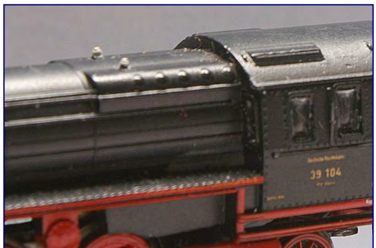
Die beiden überdimensionierten Pfeifen sind gegen vorbildgerecht große Ackermann-Sicherheitsventile getauscht worden (im Bild hellgrau grundiert).
