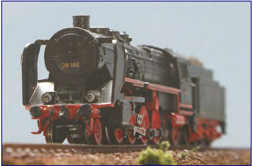
Die Arbeiten am Gehäuse sind weitgehend abgeschlossen, doch die Lampenbügel sind noch nicht montiert. Sehr gut wirkt das weiße Auslegen der Loklaternen auch nach Wiedereinsetzen des Lichtleiters.
