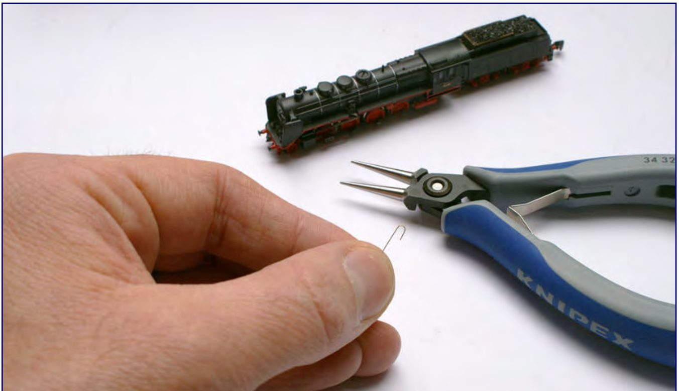
Das Formen der Lampenbügel erforderte eine hohe Präzision und ließ sich nur mit einer hochwertigen Zange von Knipex in der gewünschten Genauigkeit bewerkstelligen.
