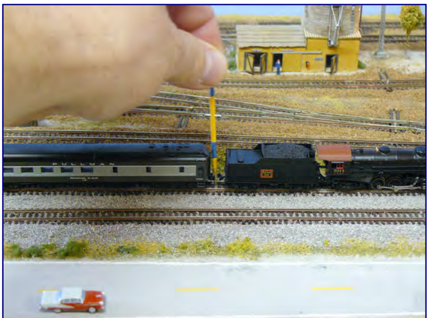
Mit etwas Übung lassen sich die AZL- und MTL-Kupplungen einfach mit Hilfe eines Zahnstochers, in dieser Funktion Kuppelstange genannt, lösen.
