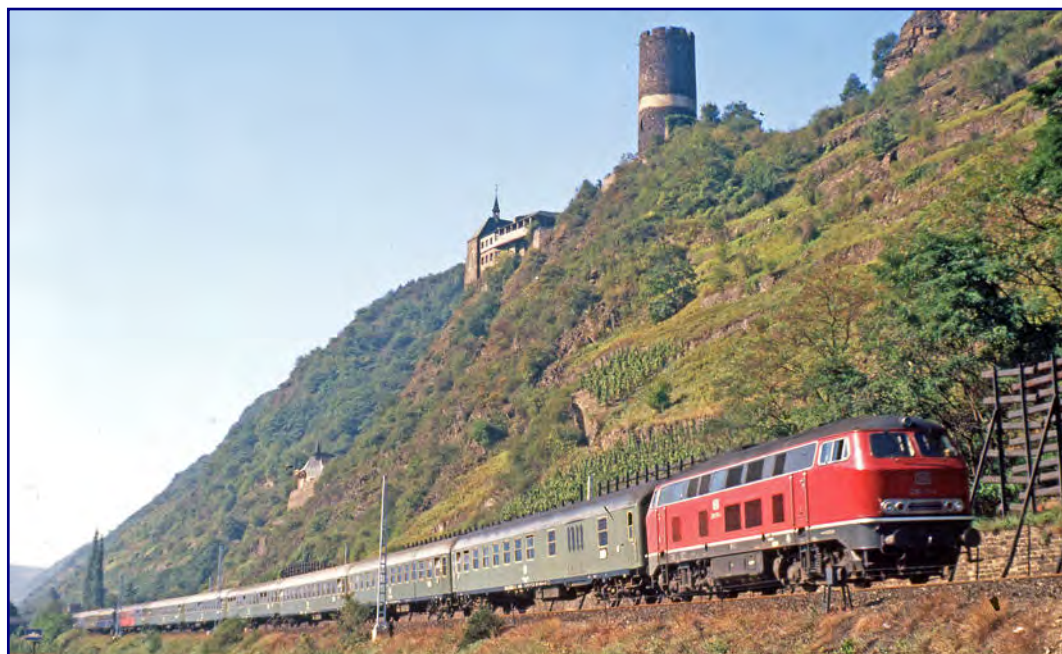
Nahe Hatzenport fährt 216 178-4 mit D 602 (Saarbrücken – Dortmund) am 8. September 1971 vor der Kulisse der Burg Bischofstein vorbei. Die neu aufgestellten Oberleitungsmasten kündigen den anstehenden Traktionswechsel zum 7. Dezember 1973 bereits an. Foto: Peter Schiffer, Sammlung Eisenbahnstiftung
