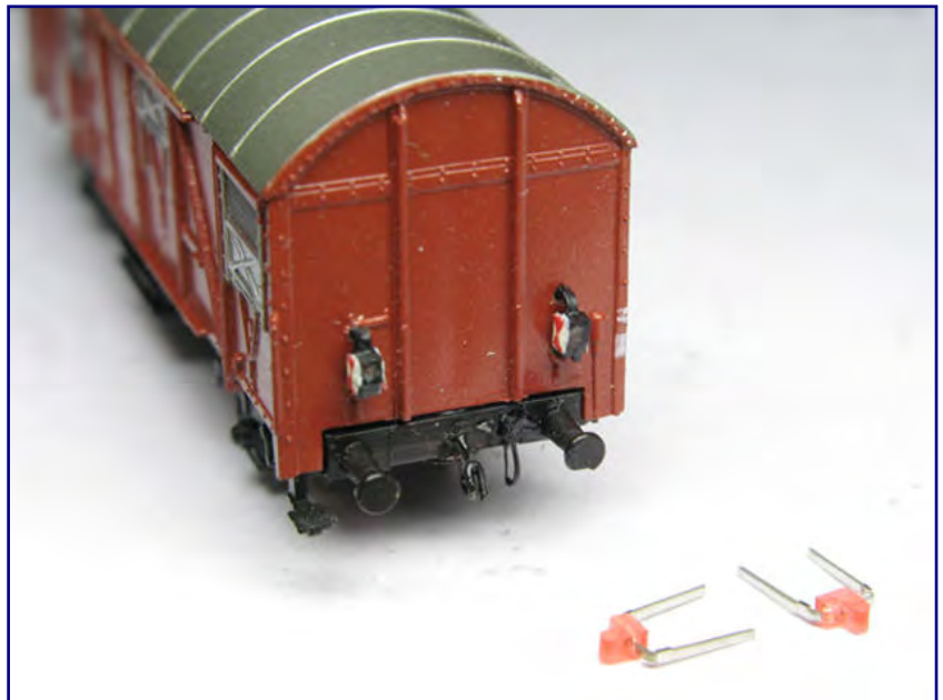
Harald Ruppelt hat seine Güterwagen-Schlusslaternen aus LED konventioneller Bauform, erhältlich bei Weinert Modellbau, hergestellt.
