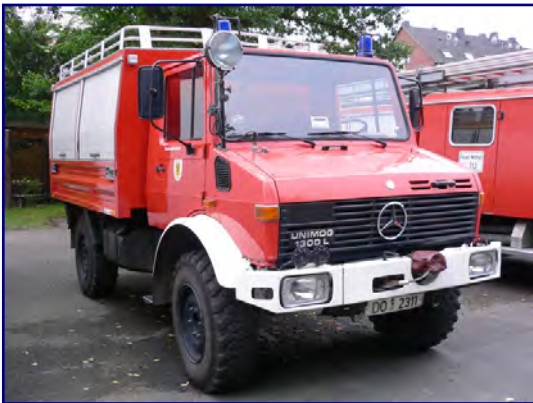
Einsatzfahrzeuge (im Bild Rüstwagen der Berufsfeuerwehr Dortmund auf Basis MB Unimog 1300L) haben ihren besonderen Reiz – in Vorbild und Modell. Foto: Mike Bonkowski
