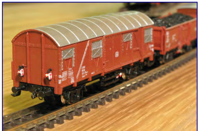
Bild oben rechts: Die Radschleifer sind aus 0,3 mm starkem Messingdraht und Federblech hergestellt und von unten an den Wagenboden geklebt.
