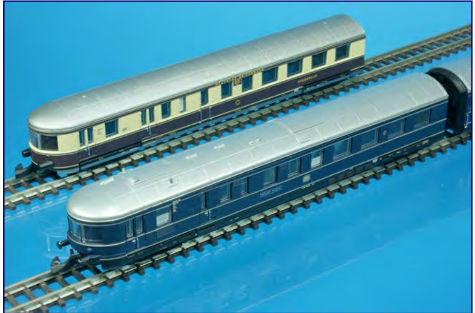
Werden der Speisewagen aus Henschel-Wegmann-Zug (hinten) und Blauem Enzian (vorne) gegenübergestellt, zeigen sich die Formabweichungen an der Front, im Dachbereich und hinsichtlich der Tür- wie auch Fensteraufteilung besonders deutlich.
