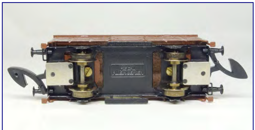
Chassis und Aufbau sind miteinander verschraubt. Die Kupplungen entsprechen denen, die auch bei Freudenreich-Wagenmodellen montiert sind. Foto: Jens Wimmel
