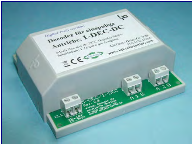
Der 4-fach-Decoder für einspulige Antriebe (Art.-Nr. 1-DEC-DC) ist u. a. für Rokuhan-Weichenantriebe gedacht. Foto: LDT Litfinski Datentechnik
