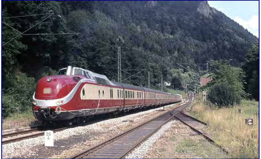
Auf der Suche nach einem neuen Einsatzzweck fanden auch Messfahrten im Schwarzwald statt: 601 017-7 und 601 018-518 werden am 8. August 1979 auf der Höllentalbahn in Posthalde bremstechnisch untersucht. Foto: Peter Schiffer, Sammlung Eisenbahnstiftung
