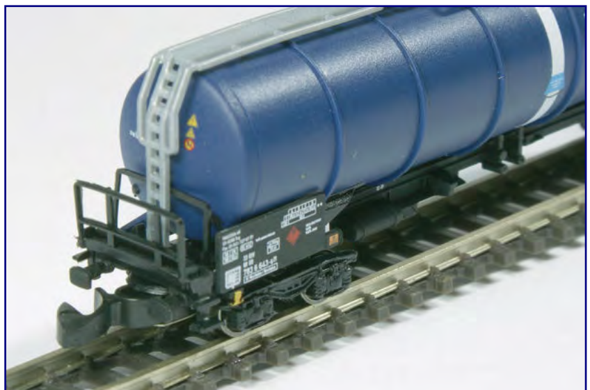
Die Rohrnachbildungen an den Seiten der Laufstege (Bild ganz oben) und die Aufstiegsleiter (Bild oben) wirken durch die Spritzgussumsetzung zu mächtig. Das ist aber auch schon das einzige, optische Manko der neuen Knickkesselwagen. Überzeugend wirken die Gravuren von Einfülldom und Entlüftungen auf dem Kesselscheitel (Bild ganz oben).
