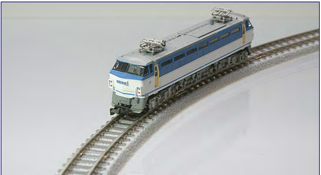
Testfahrt mit einer EF66 im überhöhten Kurvengleis R065 (Radius 220 mm): Vom Blickwinkel hängt ab, ob und wie weit die Neigung der Lok beim Durchfahren des Bogens vom Auge wahrgenommen wird.
