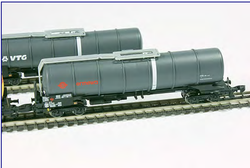
Die weiße Bauchbinde, hier vorne an einem Ermewa- und hinten an einem VTG-Waggon zu sehen, kennzeichnet die Ausstattung des Vorbilds mit einer Zwangsbelüftung.
