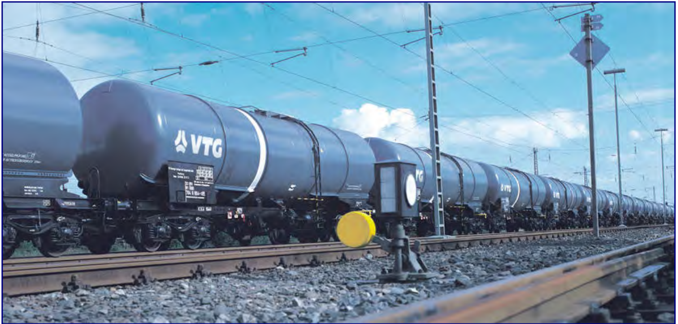
Eine senkrechte, weiße Bauchbinde kennzeichnet mit einem Zwangsbelüftungssystem ausgerüstete Wagen. Diese verhindert beim Entladen ein Implodieren des Tanks aufgrund von auftretenden Unterdrücken. Foto: VTG AG
