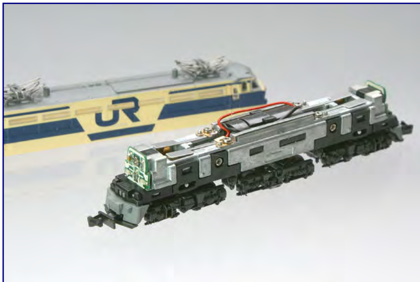
Die Beleuchtung der Stirnlichter erfolgt durch zwei gelbe LED je Fahrzeugseite. Sie sitzen auf kurzen Platinen, die auf dem Fahrgestell montiert sind.
