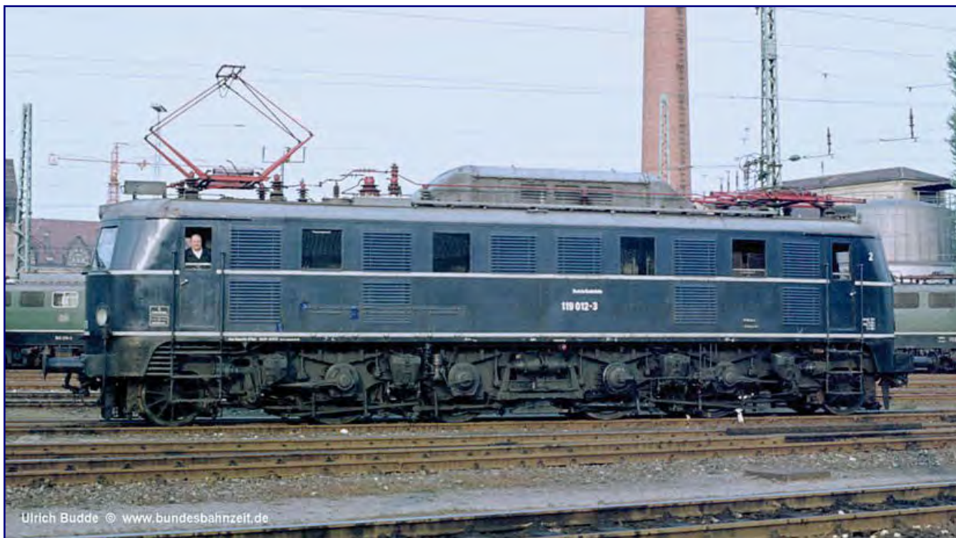
119 012-3 zeigt sich am 25. September 1976 dem Fotografen. Sie trägt zwei Neubaustromabnehmer der Bauart DBS 54, die sie erst drei Jahre zuvor erhalten hat. Gut zu sehen ist auf diesem Bild das außen liegende Bremsgestänge der beiden Henschel-SSW-Maschinen. Foto: Ulrich Budde
