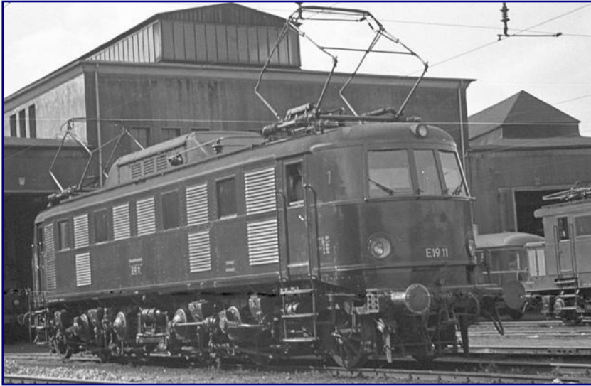
Äußerlich und technisch wichen die beiden Henschel-SSW-Lokomotiven stark von den AEG-Schwestern ab. Der rechte Puffer auf Fahrzeugseite 1 beweist, dass E 19 11 einen Puffertellerwarnanstrich besaß, als sie sich um 1959 dem Fotografen zeigte. Foto: Walter Patzke, Sammlung Petkelis
