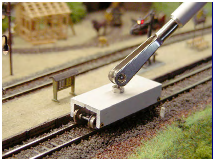
Auf die bewährten Jörger-Reinigungsfilze wollte Götz Guddas nicht verzichten. Doch ihm fehlte ein Gerät, mit dem er alle Strecken auf seiner Anlage erreichen konnte, ohne Schäden an der Ausstattung zu riskieren. Ergebnis ist sein hier vorgestellte Gleisreiniger.
