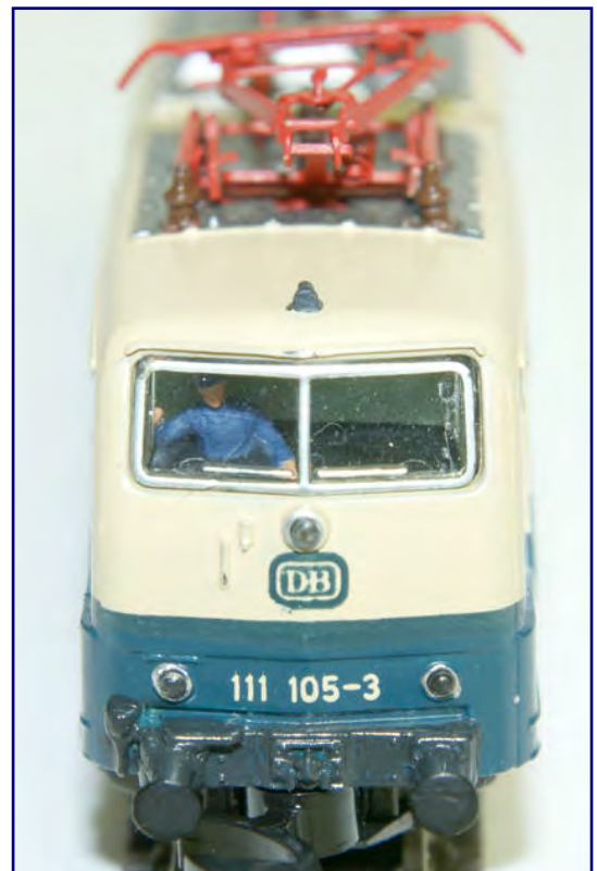
Verschleißpufferbohle und Signalhörner wurden schwarzgrau lackiert, die Lampenringe chromsilberfarben hervorgehoben.
