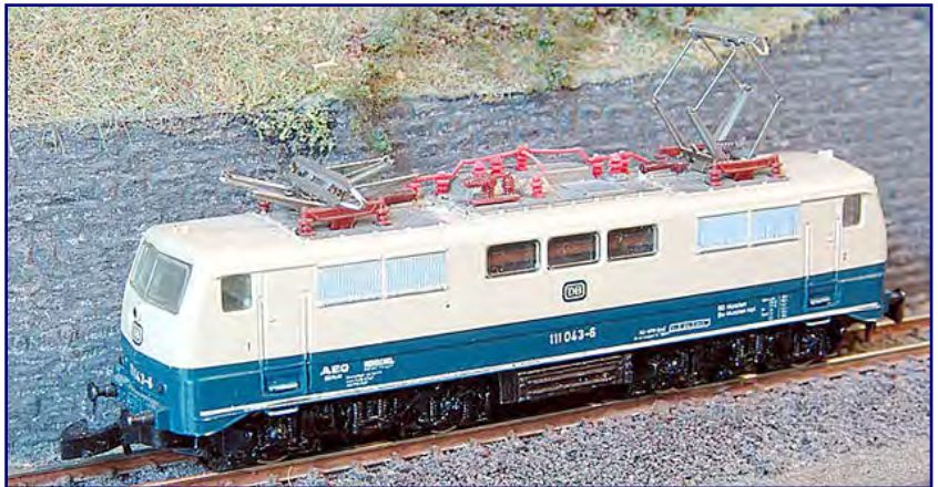
Jens Wimmel hat sein Modell vor der Superung fotografiert: Verbesserungsmöglichkeiten bieten die Dachgestaltung, die Pufferbohle und die Maschinenraumbenutzer, durch die der Blick auf die rötlich schimmernde Platine fällt. Foto: Jens Wimmel
