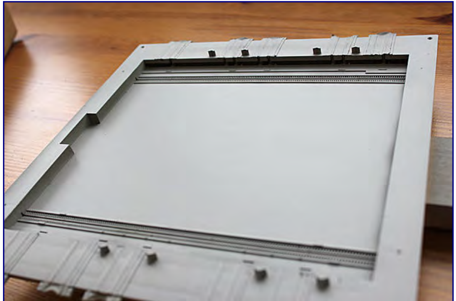
Nach der Demontage und dem Abkleben der Gleisanschlüsse erhielt die gesamte Grundplatte der Schiebebühne eine betongraue Lackierung.
