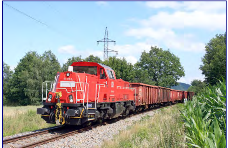
Mit ihrer gegenwärtigen Aufstellung und modernen Fahrzeuge, wie hier ihrer aktuell modernsten Diesellok Baureihe 261 vom Typ „Voith Gravita 10 BB“, sieht sich die DB für den Wettbewerb gut gerüstet. Foto: Deutsche Bahn AG/Jochen Schmidt
