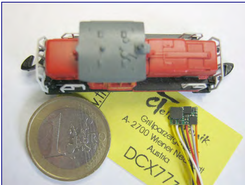
Mit seinen winzigen Abmessungen eignet sich der neue Decoder DCX77z von CT perfekt für Spur-Z-Modelle. Im Bild zu sehen ist die Ausführung als DCX77zD mit sechs Drähten. Foto: Virágh István
