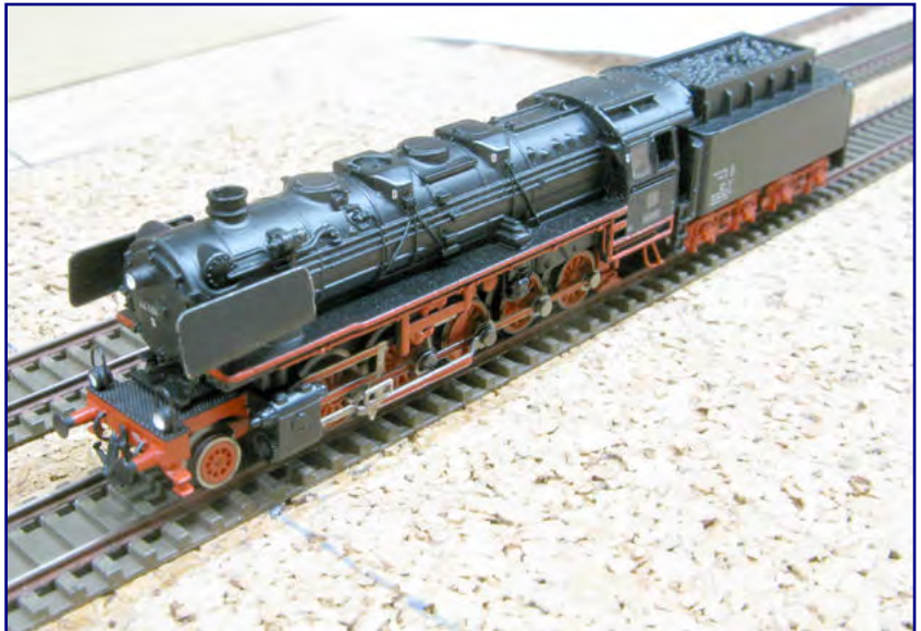
Die Erfolge von Dirk Rohwerders Umbau zeigen sich besonders im Bereich der Lokfront. Endlich zeigt auch das Modell den fürs Vorbild typischen Abschluss der Windleitbleche mit der Pufferbohle.
