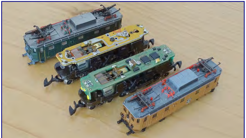
In der Gegenüberstellung der alten Analogplatine (hinten) und der neuen Digitallösung (vorne) ist noch ein Prototyp des Decoders zu sehen, der leicht von der Serienausführung abweicht. Foto: Jens Wimmel (ZettZeit)
