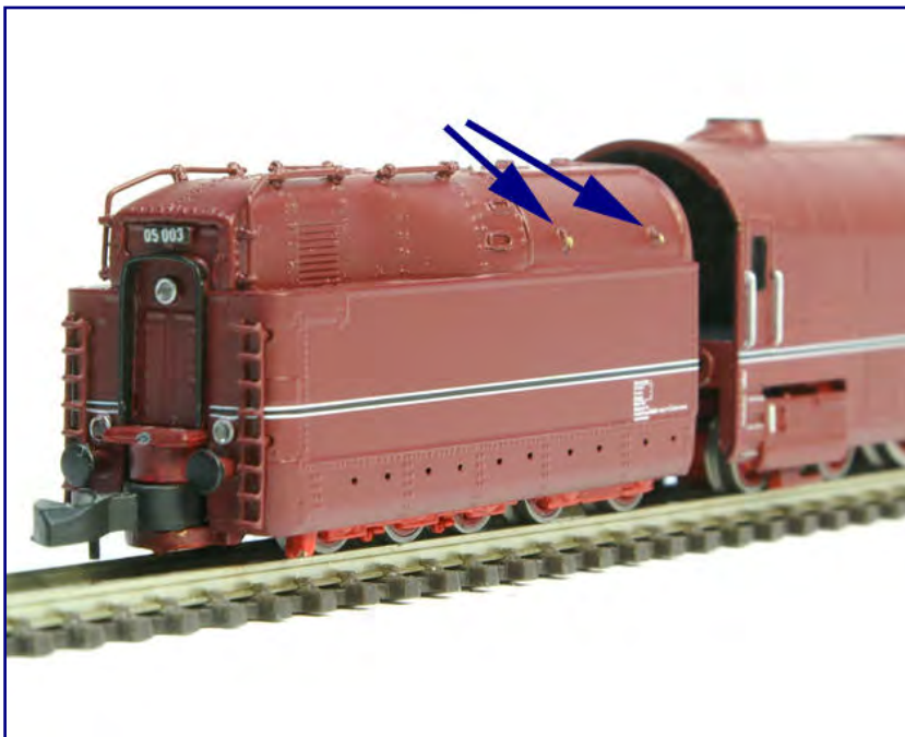
Als Ausrutscher der insgesamt sauberen Lackierung sind uns drei blanke Stellen am Tender aufgefallen, von denen wir zwei in dieser Aufnahme markieren konnten.
