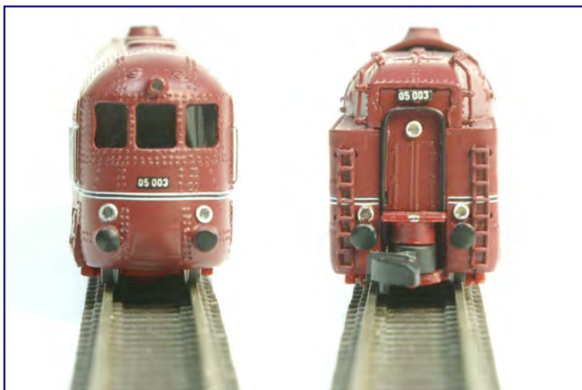
Front- und Rückansicht bildlich gegenübergestellt: Angenehm fallen die angesetzten und daher freistehenden Leitern und Stangen auf. Was nicht ins Bild passen will, ist der von der großen Kupplungsaufnahme unterbrochene Faltenbalg, der kaum noch Platz fürs Fabrikschild lässt.
