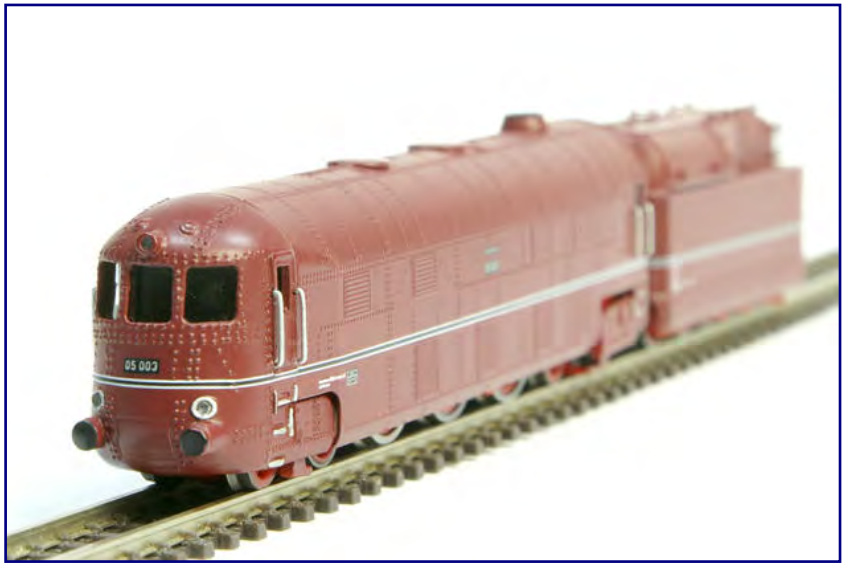
Kaum wahrnehmbar ist die Folie hinter den Frontfenstern – hier hätte einer vorbildgerechten Lösung mittels Klarsichtteilen der Vorzug gegeben werden sollen. Ebenfalls nicht korrekt ist die Form der Griffstangen an den Führerstandsauftiegen.
