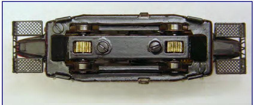
Die beiden Zahnräder auf den Achsen liegen nach unten frei. Auch auf dieser Aufnahme zeigen sich wieder die sehr filigranen Trittbleche an den Vorbauten. Foto: Götz Guddas
