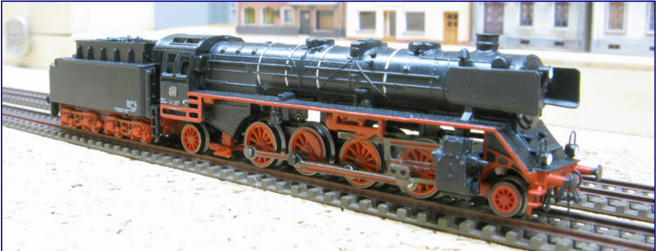
Aus dieser Perspektive werden einige der Arbeiten am Fahrwerk sichtbar: größeres Gegengewicht an der Treibachse, Durchsicht unter dem Kessel oder die Nachbildung von Nachlaufgestell samt Indusi-Magnet. Foto: Dirk Rohwerder
