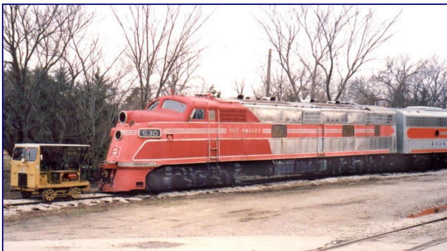
Diese Lokomotive mit der Betriebsnummer 630 der Rock Island Rock Island, eine EMD E6A des Baujahrs 1941, zeigt noch die Merkmale, wie sie bis zu den frühen Bauserien der E7 Bestand hatten: flacher geneigte Front, eckige Maschinenraumfenster und Einzellüfter. Foto: Russell Meier/CC BY-SA 3.0
