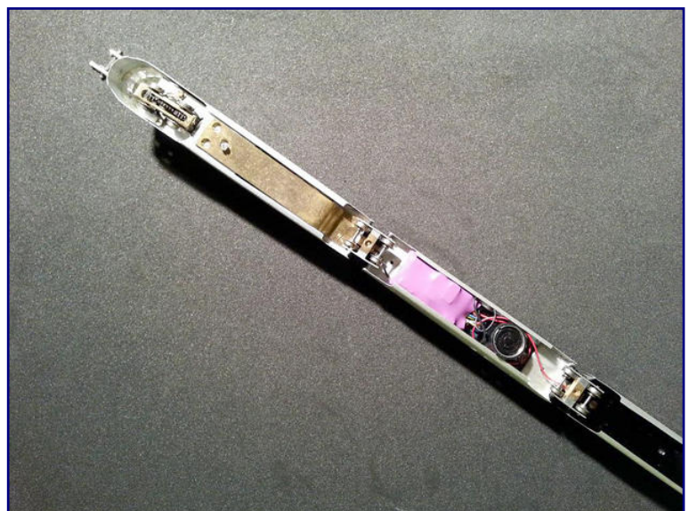
Blick ins Innenleben mit dem selbstgefrästen Fahrwerksblock und Geräuschdecoder.
