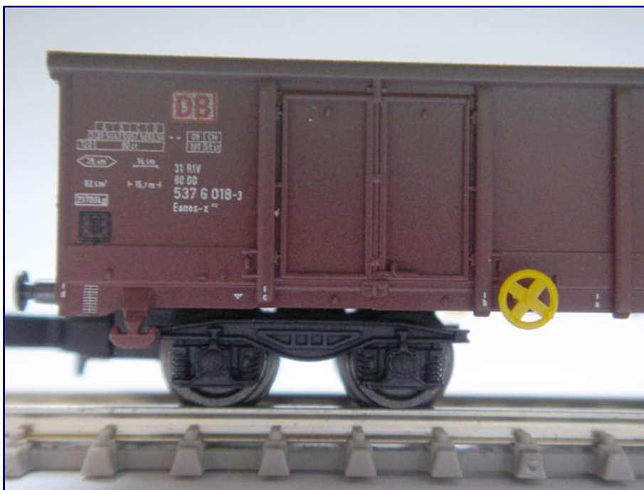
Seine vielleicht bedeutendste Kernkompetenz hat Märklin auch beim Jahreswagen unter Beweis gestellt: Absolut maßstäblich und lupenrein bis ins kleinste Zeichen fällt die mehrfarbige Bedruckung aus. Schwarz aufgestempelt ist der Zettelkasten.
