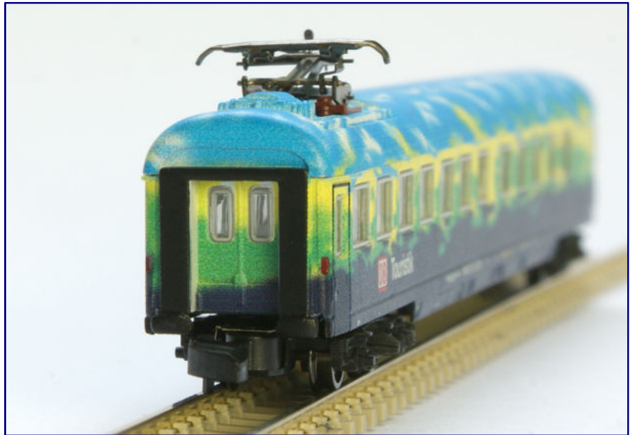
Beim WRmz 137 handelt es sich um die erste Spur-Z-Nachbildung eines druckertüchtigten Wagens. Die typische Form der Gummiwülste und Schlussleuchten hat Märklin korrekt berücksichtigt. Hinzu kommen Fenstereinsätze in den Übergangstüren.
