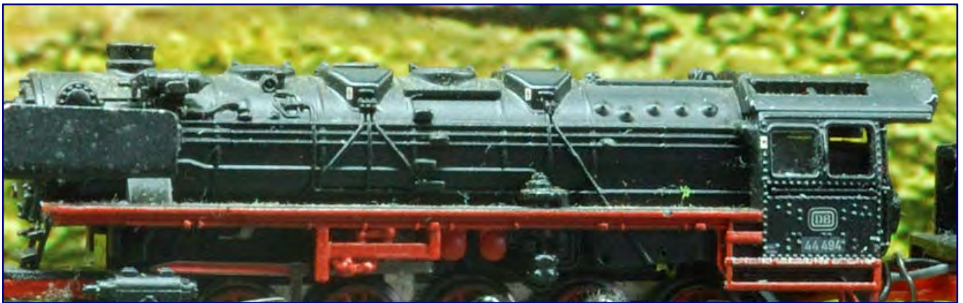
Führerstandsseitenfenster aus gefrästem Klarsichtpolystyrol gibt es nun auch für die Baureihen 50 (Art.-Nr. 16013) und 44 (16014; im Bild). Zwei weitere Scheibensätze sind aktuell in Vorbereitung. Foto: Rainer Tielke
