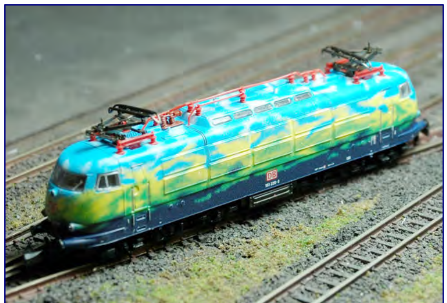
Aufwändiger in der Herstellung sind die Maschinenraumfenster für die Baureihe 103 (16011) aus Acrylglas. Foto: Rainer Tielke
