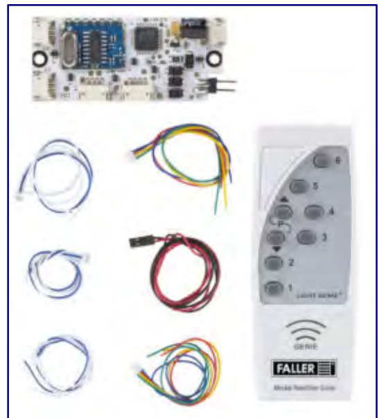
Das „Light Genie“ (180703) steuert die Anlagenbeleuchtung in fünf verschiedenen Lichtzonen. Foto: Faller
