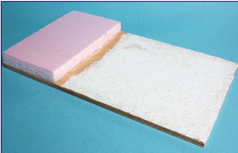
Ein Stück Raufasertapete mittlerer Körnung wird mit der „guten“ Seite nach unten auf den Untergrund geklebt.
