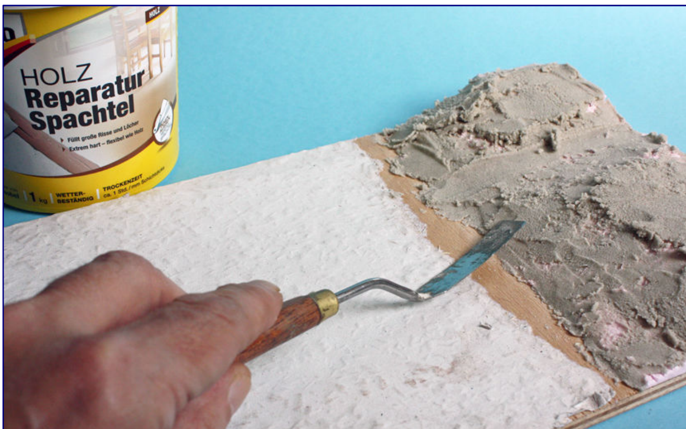
Mit scharfen Werkzeugen wird die Styrodur-Auflage in Form gebracht, bis sie keine glatten Flächen mehr hat (Bild oben). Dann folgt ein Überzug mit Holz-Reparaturspachtel (Bild unten).
