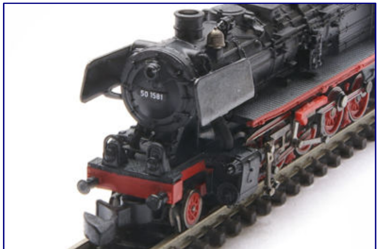
Das Anbringen der Detailsteuerung ging auch hier nicht um einen (kaum sichtbaren) Breitenzuwachs. Kleinere Fehler wie das zu hohe Anbringen der Speise- und Luftpumpe sind geblieben.
