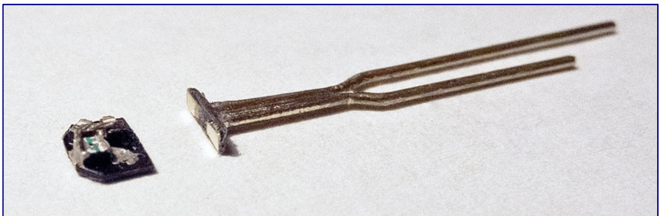
Ausgetüfelt ist auch die Stromzuführung ins Signal mittels Messingrohren und den plattgedrückten Drahtenden, die voneinander weg zeigen, um keinen Kurzschluss zu riskieren.
