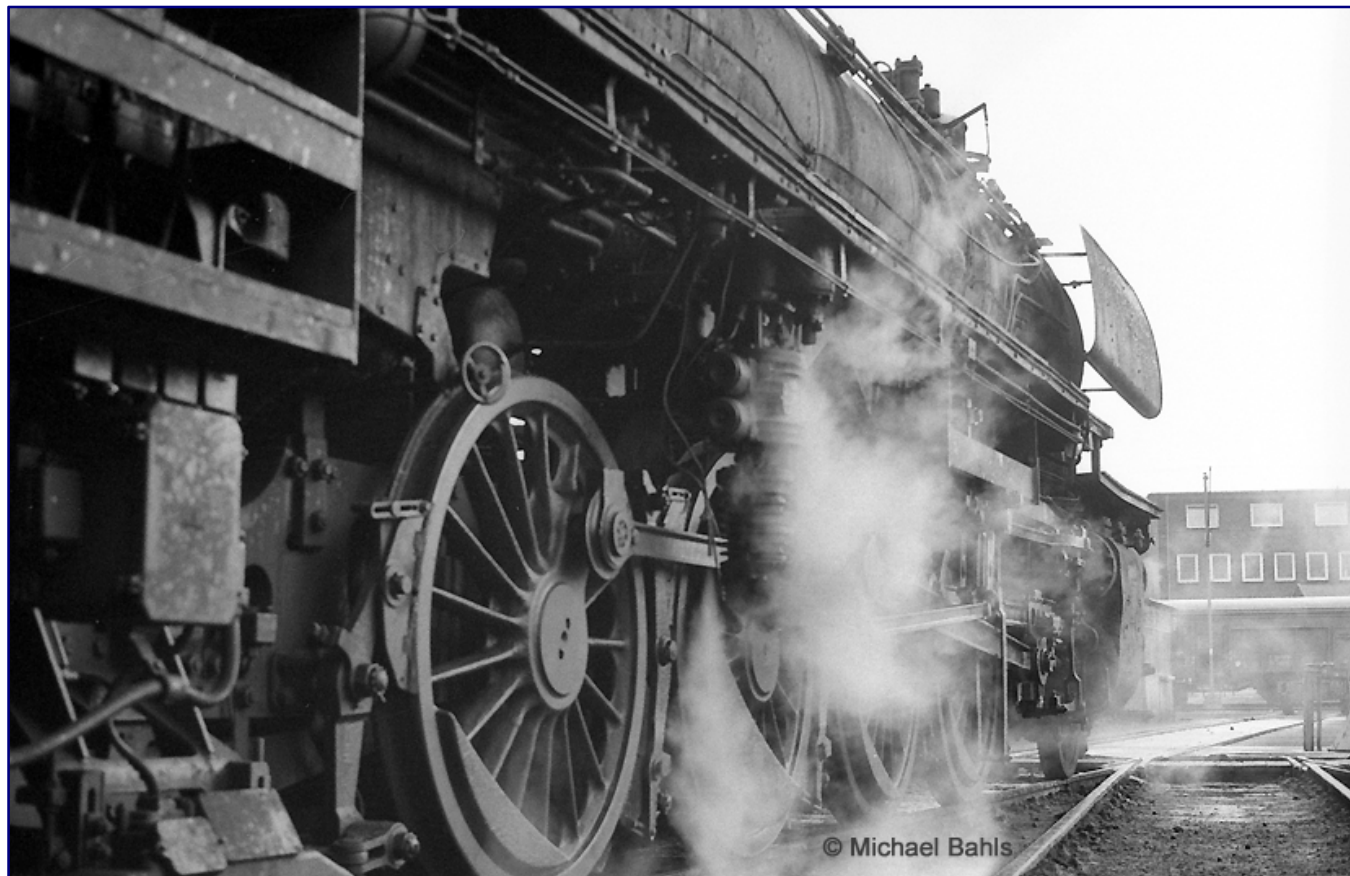
Eine ölgefeuerte Dampflokom der Baureihe 042 wartet an der Drehscheibe des Bw Rheine auf ihren nächsten Einsatz.
